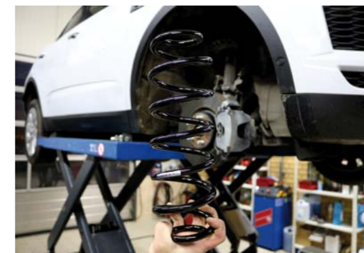
PRZY OKAZJI OBSŁUGI AMORTYZATORÓW NALEŻY ZAWSZE SPRAWDZAĆ STAN SPRĘŻYN
