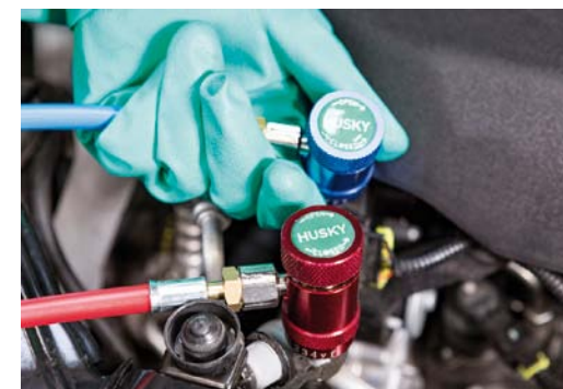
PODŁĄCZENIE STACJI SERWISOWEJ DO OBIEGU CHŁODNICZEGO
