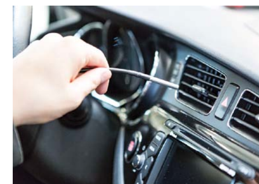
POMIAR TEMPERATURY NAWIEWANEGO POWIETRZA
