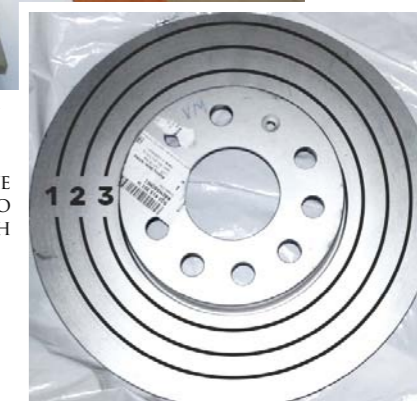
FOT. 3: STANOWISKO POMIAROWE DO POMIARU BICIA OSIOWEGO TARCZ HAMULCOWYCH
