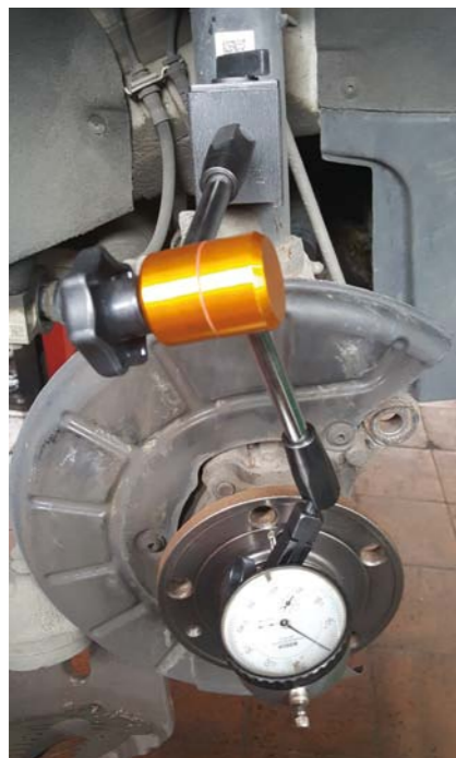
FOT. 5. POMIAR BICIA PIAST WYKONUJE SIĘ CZUJNIKIEM ZEGAROWYM
