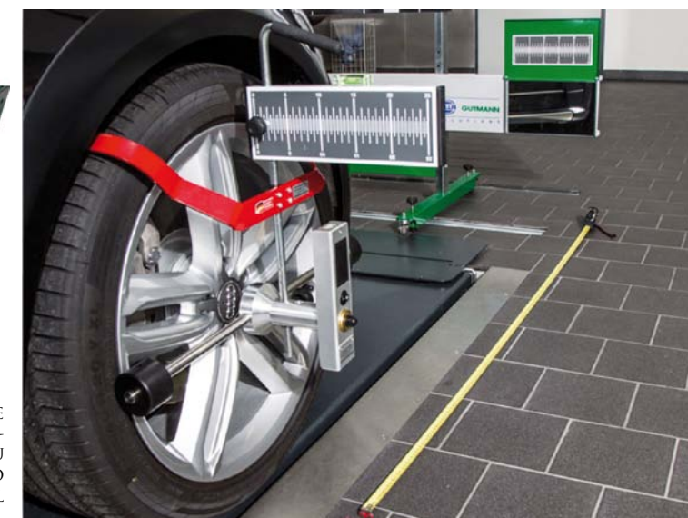
MOCOWANIE BOCZNEGO ELEMENTU BAZOWEGO DO KOŁA OBSŁUGIWANEGO POJAZDU
