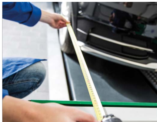
WYZNACZANIE ODLEGŁOŚCI WYMAGANYCH W INSTRUKCJI OBSŁUGI NARZĘDZIA KALIBRACYJNEGO
