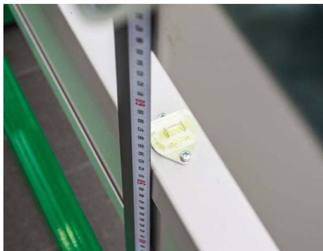
USTAWIANIE ELEMENTÓW SYSTEMU KALIBRACYJNEGO WEDŁUG LINII NA POSADZCE STANOWISKA DIAGNOSTYCZNEGO
