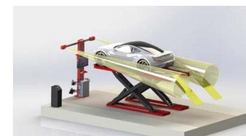
„KĄT WIDZENIA” TYPOWYCH SYSTEMÓW DWUKAMEROWYCH
