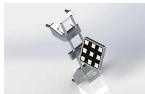
TARCZA REFLEKSYJNA MOCOWANA DO KOŁA BADANEGO POJAZDU
