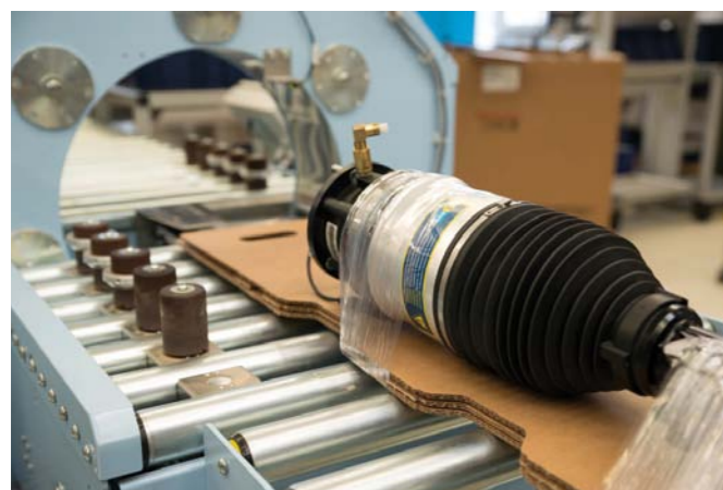
ZINTEGROWANE KOLUMNY ZAWIĘSI PNEUMATYCZNYCH BILSTEIN NA KOŃCU FABRYCZNEJ TAŚMY MONTAŻOWEJ (Z LEWEJ) I W TRAKCIE KOŃCOWEJ KONTROLI TECHNICZNEJ
