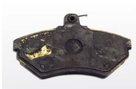
ROZWARSTWIENIE OKŁADZINY CIERNEJ Z POWODU PRZECIĄŻEŃ TERMICZNYCH
