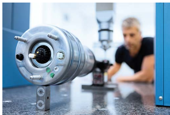
ZINTEGROWANE KOLUMNY ZAWIĘSI PNEUMATYCZNYCH BILSTEIN NA KOŃCU FABRYCZNEJ TAŚMY MONTAŻOWEJ (Z LEWEJ) I W TRAKCIE KOŃCOWEJ KONTROLI TECHNICZNEJ
