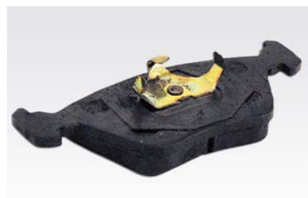
USZKODZENIE SPRĘŻYSTEGO ZACZĘPU PODCZAS NIEPRAWIDŁOWEGO MONTAŻU
