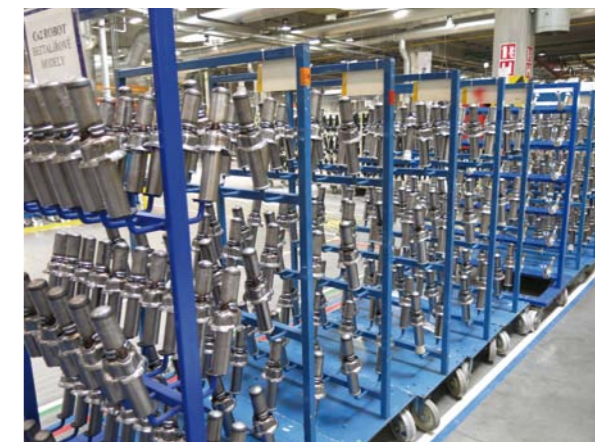
KMCZ – GOTOWE ZEWNĘTRZNE CYLINDRY AMORTYZATORÓW DWURUROWYCH
