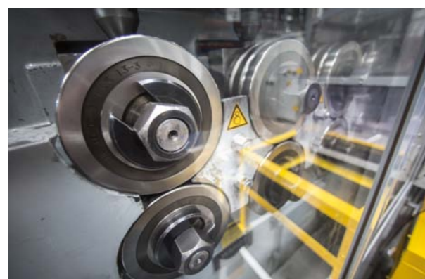
KCME – MASZYNA FORMUJĄCA ZWOJE SPRĘŻYN SPIRALNYCH
