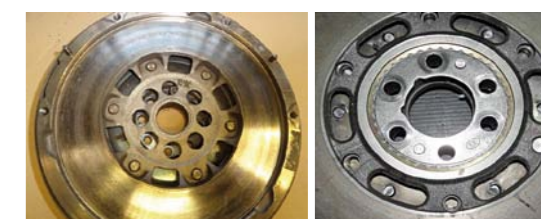
ZABLOKOWANIE DKZ ŚCIECIE NITÓW SPOWODOWANE REZONANSEM PRZEZ PĘKNIĘTE SPRĘŻYNY
