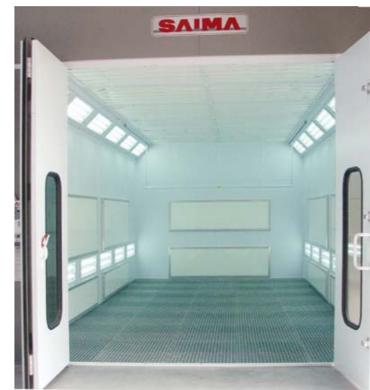
WNĘTRZE KABIN Z POZIOMO ZAMOCOWANYMI PANELAMI ENDOTERMICZNYMI
