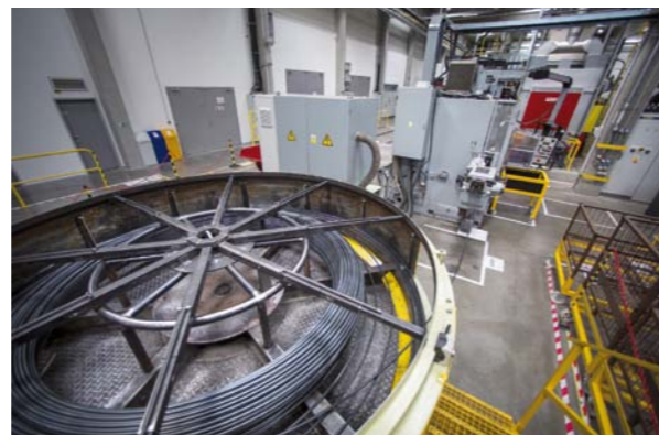
KCME – MASZYNA PROSTUJĄCA ZWOJE DRUTU SPRĘŻYNOWEGO
