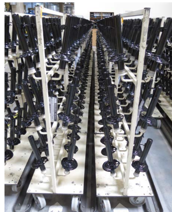
KMCZ – LAKIEROWANIE ZEWNĘTRZNYCH POWIERZCHNI AMORTYZATORÓW
