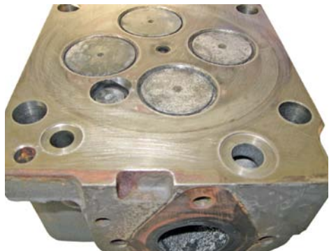
PRZYCZYNY WEWNĘTRZNYCH WYCIEKÓW OLEJU I/LUB PŁYNU CHŁODZĄCEGO: U GÓRY – NIEPRAWIDŁOWY MONTAŻ USZCZELKI, U DOŁU – NIEDOSTATECZNA GŁADKOŚĆ PŁASZCZYZNY GŁOWICY
