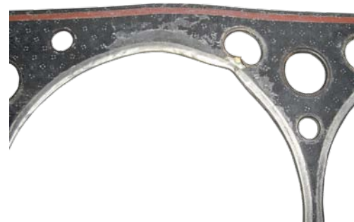
MECHANICZNE USZKODZENIE USZCZELKI BĘDĄCE EFEKTEM BŁĘDÓW MONTAŻOWYCH
