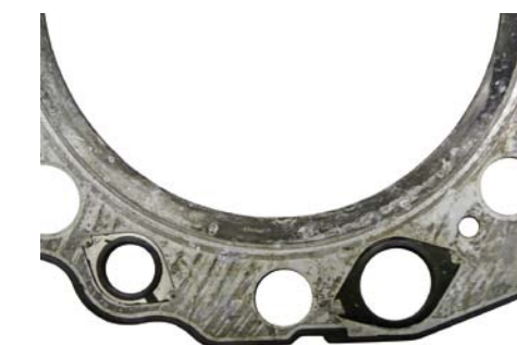
USZKODZONE USZCZELKI ZE ŚLADAMI PRZEDMUCHÓW GAZÓW SPALINOWYCH
