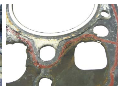
NIESZCZELNOŚCI NA STYKU GŁOWICY Z KADŁUBEM SILNIKA MOGĄ BYĆ POWODOWANE NIEDOKŁADNYM OSZLIFOWANIEM POWIERZCHNI (DWA Z LEWEJ) ALBO AGRESYWNYMI SKŁADNIKAMI PŁYNU CHŁODZĄCEGO (DWA Z PRAWYJ)
