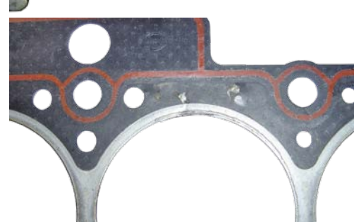
WPŁYW TZW. SPALANIA STUKOWEGO NA USZKODZENIA RÓŻNYCH KONSTRUKCJI USZCZELNIEŃ PODGŁOWICOWYCH
