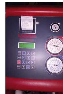
STANDARDEM W AUTOMATYCZNYCH STACJACH SERWISOWYCH JEST WBUDOWANA DRUKARKA I BAZA DANYCH
