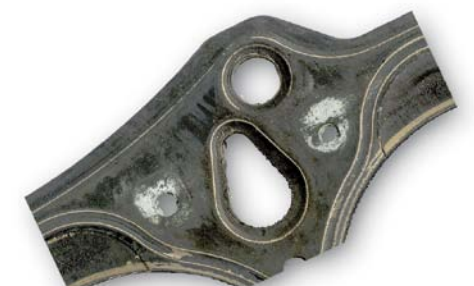
USZKODZONA PRZEDMUCHAMI USZCZELKA MOTOCYKLOWA O DWUWARSTWOWEJ KONSTRUKCJI METALOWEJ
