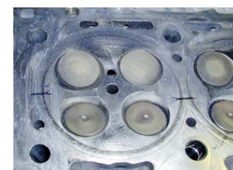
NIESZCZELNOŚCI NA STYKU GŁOWICY Z KADŁUBEM SILNIKA MOGĄ BYĆ POWODOWANE NIEDOKŁADNYM OSZLIFOWANIEM POWIERZCHNI (DWA Z LEWEJ) ALBO AGRESYWNYMI SKŁADNIKAMI PŁYNU CHŁODZĄCEGO (DWA Z PRAWYJ)
