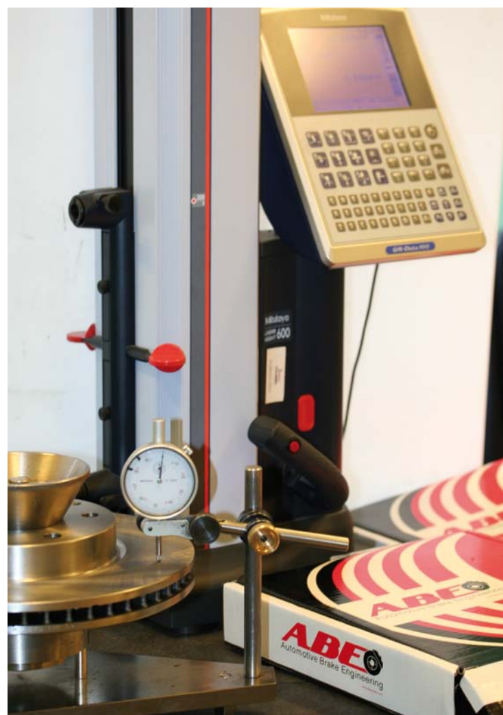
BADANIE PARAMETRÓW GEOMETRYCZNYCH TARCZY NA STANOWISKU POMIAROWYM
