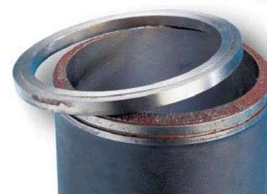
MECHANICZNE USZKODZENIE USZCZELKI BĘDĄCE EFEKTEM BŁĘDÓW MONTAŻOWYCH
