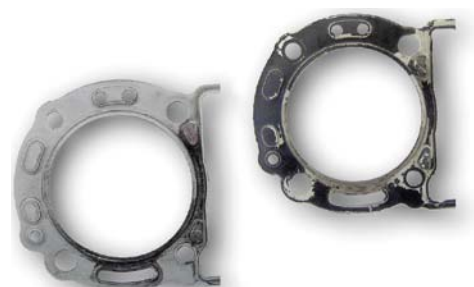
USZKODZONA PRZEDMUCHAMI USZCZELKA MOTOCYKLOWA O DWUWARSTWOWEJ KONSTRUKCJI METALOWEJ
