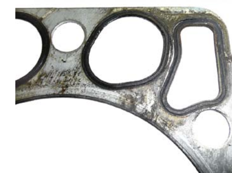
CHARAKTERYSTYCZNE USZKODZENIA POWODUJĄCE PRZEDMUCHY GAZÓW
