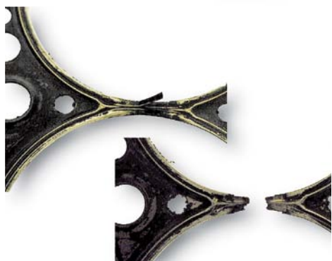
NAJBARDZIEJ PODATNE NA POWSTAWANIE PRZEDMUCHÓW SĄ PRZEWEŻENIA USZCZELKI POMIĘDZY SĄSIEDNIMI CYLINDRAMI
