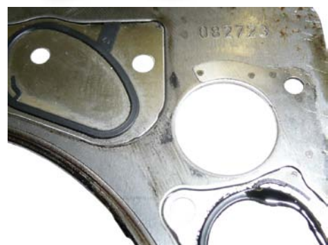
SKUTKI PRZEDMUCHU GAZÓW SPALINOWYCH DO OBIEGU CHŁODZENIA
