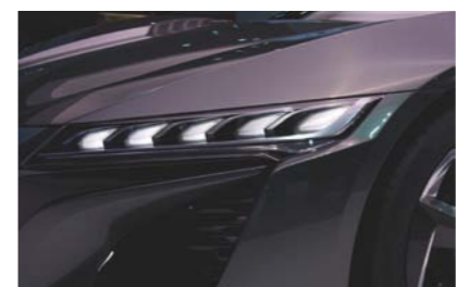
ŚWIATŁA DZIENNE LED WKOMPONOWANE W ARCHITEKTURĘ POJAZDU
