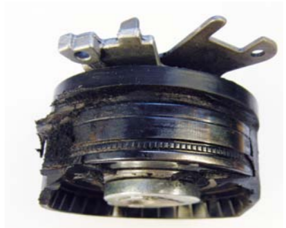
1. rolka napinająca 2. wskaźnik 3. nakrętka rolki napinającej
