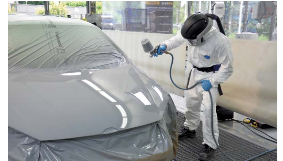
WYPEŁNIACZ STANDOX VOC XTREME FILLER U7600 MOŻNA APLIKOWAĆ DYSZĄ O MNIEJSZYM ROZMIARZE, NP. O ŚREDNICY 1,4 MM, I POD MNIEJSZYM CIŚNIENIEM. GDYŻ W TEN SPOSÓB OTRZYMUJEMY PŁASKI STRUMIEN I OGRANICZAMY MGŁĘ NATRYSKOWĄ DO MINIMUM, CO UŁATWIA SZLIFOWANIE
