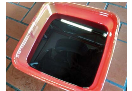
METODĄ STATYCZNĄ WYMIENIĆ MOŻNA NAJWIĘCEJ 40 DO 60% ZUŻYTEGO OLEJU ZNAJDUJĄCEGO SIĘ W SKRZYNI
