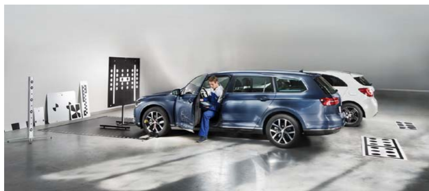
OPRZYRĄDOWANIE TEXA DO KALIBRACJI „POLA WIDZENIA” KAMER
