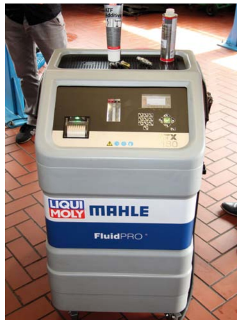
URZĄDZENIE DO DYNAMICZNEJ WYMIANY OLEJU W PRZEKŁADNIACH AUTOMATYCZNYCH PRODUKOWANE
