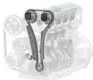
ŁAŃCUCH ROZRZĄDU ZAPEWNIĄ PRECYZYJNĄ WSPÓŁPRACĘ MECHANICZNYCH CZĘŚCI SILNIKA
