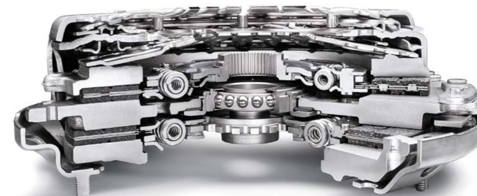
TOLERANCJE KAŻDEGO Z DWU SPRZĘGIEŁ SKRZYNI DSG MUSZĄ SIĘ MIEŚCIĆ W GRANICACH OKREŚLONYCH FABRYCZNĄ INSTRUKCJĄ MONTAŻU
