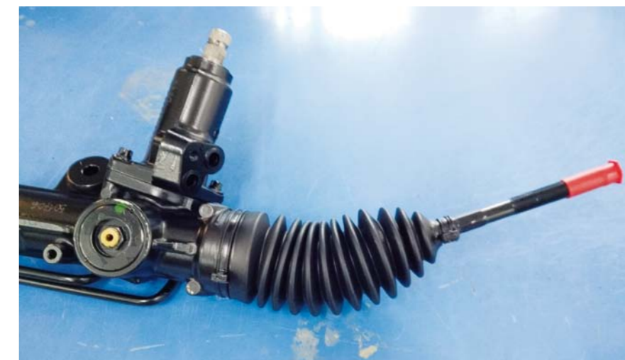
PLASTIKOWE OSŁONY GWINTOWANYCH KOŃCÓWEK DRĄŻKÓW KIEROWNICZYCH USUWA SIĘ TUŻ PRZED ICH POŁĄCZENIEM ZE SWORZNIAMI KULISTYMI
