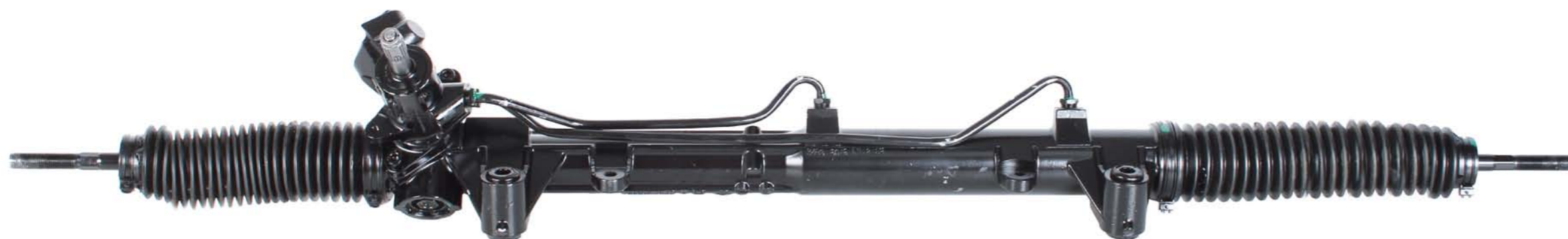
REGENEROWANA PRZEKŁADNIA ZĘBĄTKOWA ZE WSPOMAGANIEM HYDRAULICZNYM
