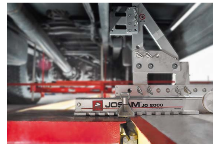
STANOWISKO DO PROSTOWANIA RAM POJAZDÓW W WERSJI KANAŁOWEJ
