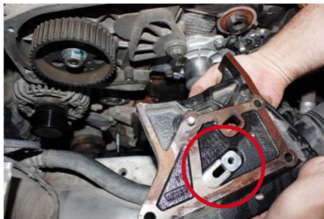
NAKRĘTKA MOCOWANIA NAPINACZA PASKA WYMAGAJĄCA KAŻDORAŻOWEJ WYMIANY
