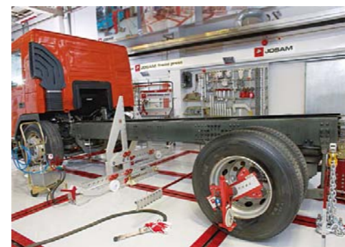
STANOWISKO DO PROSTOWANIA RAM POJAZDÓW OSADZONE W PŁASKIEJ PODŁODZE WARSZTATU
