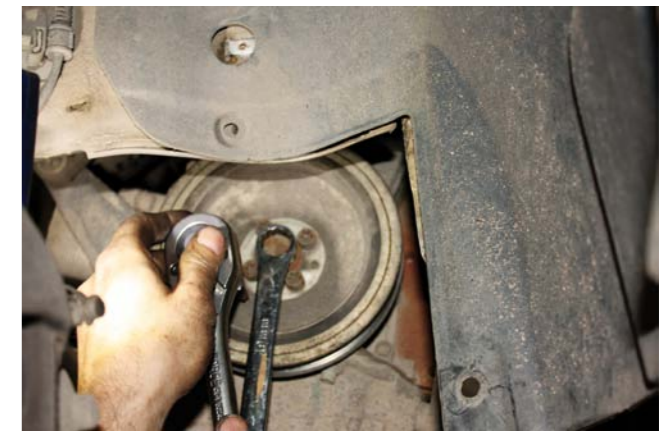
USTAWIANIE WAŁÓW KORBOWEGO I ROZRZĄDU PRZED ROZPOCZĘCIEM DEMONTAŻU
