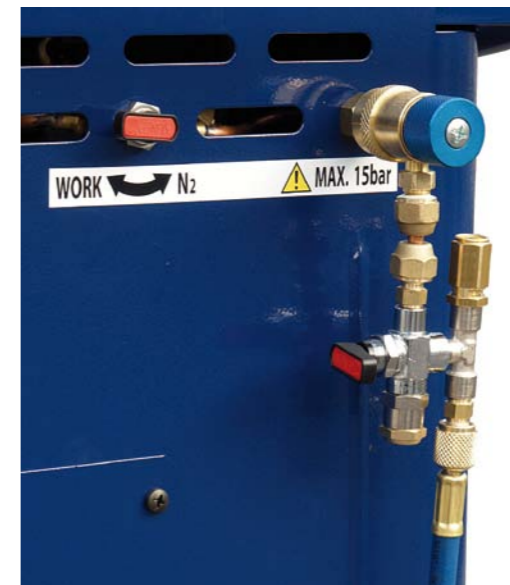
PODŁĄCZENIE BUTLI Z AZOTEM DO STACJI SERWISOWEJ W CELU WYKONANIA NADCIŚNIENIOWEGO TESTU SZCZELNOŚCI
