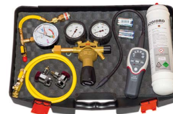
PODŁĄCZENIE BUTLI Z AZOTEM DO STACJI SERWISOWEJ W CELU WYKONANIA NADCIŚNIENIOWEGO TESTU SZCZELNOŚCI
