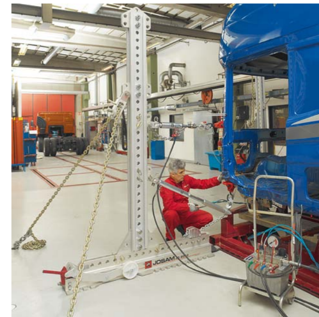
ZAMOCOWANIE ŁAWY NAPRAWY KABIN DO TULEI KOTWIONYCH W POSADZCE POZA RAMĄ GŁÓWNAJĄ
