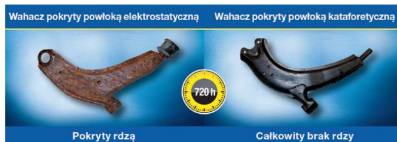
TEST ODPOORNOCI WAHACZA NA KORYZJĘ; REZULTATY PO 720 GODZINACH W KOMORZE SOLNEJ, CO ODPOWIADA OKRESOWI OKOŁO 8-10 LAT EKSPLOATACJI W EUROPIE
