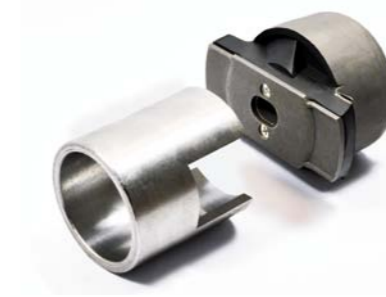
FOT. 7. NIETYPOWA TULEJA I PRZYRZĄD SŁUŻĄCY DO JEJ WCISKANIA
