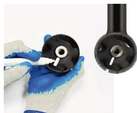
FOT. 1. OZNACZENIE POZYCJI STAREJ TULEI WZGLĘDEM WAHACZA I ZNAKOWANIE NOWEJ
