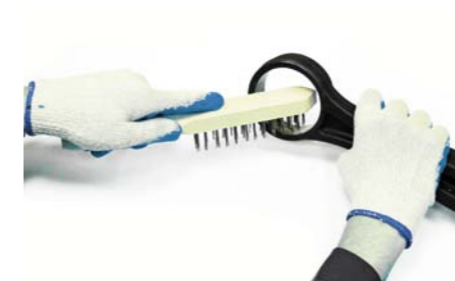
FOT. 4. DOKŁADNE CZYSZCZENIE GNIAZDA WAHACZA PRZED WPRASOWANIEM NOWEJ TULEI
