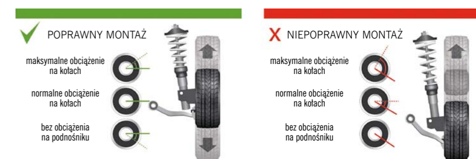
FOT. 11. ZACHOWANIE ZAMONTOWANEJ TULEI METALOWO-GUMOWEJ PRZY RÓŻNYCH OBCIĄŻENIACH ZAWIESZENIA
