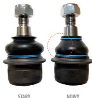
STARY NOWY NOWY KSZTAŁT GUMOWEJ OSŁONY SWORZNIA POPRAWIŁ JEGO JAKOŚĆ I WYDŁUŻYŁ CZAS EKSPLOATACJI
