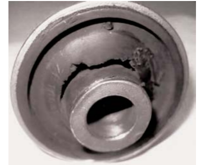
ZERWANIE GUMOWEGO ELEMENTU TULEI Z POWODU NIEPRAWIDŁOWEGO MONTAŻU WAHACZA
