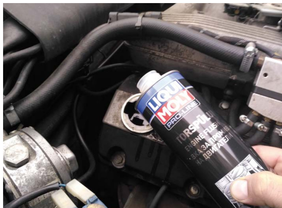
SPOSÓB APLIKACJI PREPARATU MYJĄCEGO ENGINE FLUSH LIQUI MOLY NR ART. 2662
