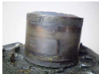
RYS. 4. ZATARTA POMPA WODY KRÓTKO PO WYMIANIE PASKA
