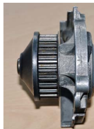
RYS. 2. OSTRA KRAWĘDŹ BIEŻNI KOŁA PASOWEGO
