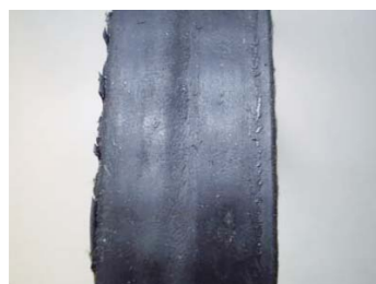
RYS. 5. SPALONY PASEK ROZRZĄDU. WSPÓŁPRACUJĄCY Z ZATARTĄ POMPĄ
