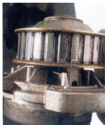
RYS. 6. NADMIERNIE ZUŻYTE KOŁO PASOWE (CHARAKTERYSTYCZNY ZARYS ZĘBÓW)
