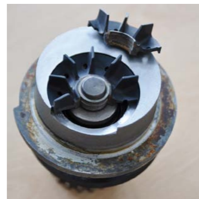
RYS. 7. USZKODZONY (PĘKNIĘTY) WIRNIK POMPY WODY
