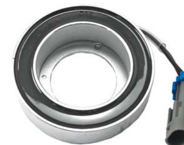
ELEKTROMAGNETYCZNE SPRĘGŁO SPRĘŻARKI KLIMATYZACYJNEJ
