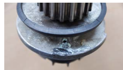
RYS. 8. ZAŚLEPIENIE OTWORU ODPOWIEETRZAJĄCEGO SILIKONEM
