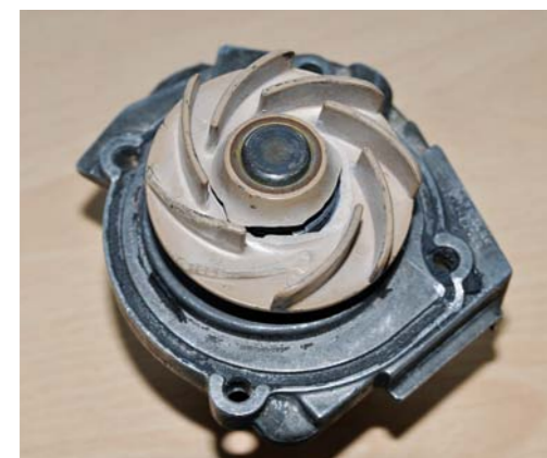
RYS. 1. USZKODZENIE WIRNIKA W WYNIKU NIEPRAWIDŁOWEGO MONTAŻU
