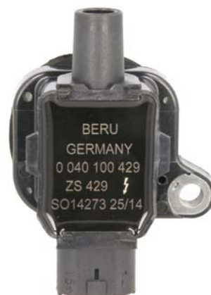
KOMPAKTOWA KONSTRUKCJA CEWKI DWUISKROWEJ OBSŁUGUJĄCEJ JEDNĄ PARĘ CYLINDRÓW
