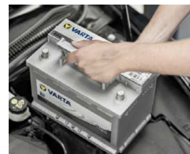
PRAWIDŁOWE ZAMONTOWANIE AKUMULATORA ELIMINUJE JEGO PRZEMIESZCZANIE I WIBRACJE
