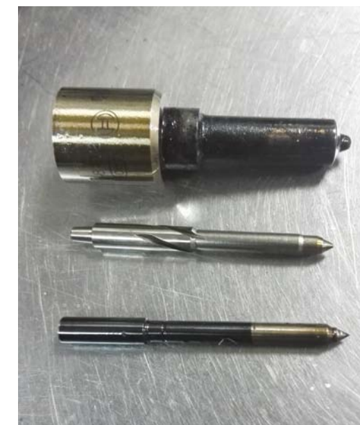
ZANIECZYSZCZONA KOŃCÓWKA ROZPYLACZA ORAZ CZYSTA I BRUDNA IGLICA
