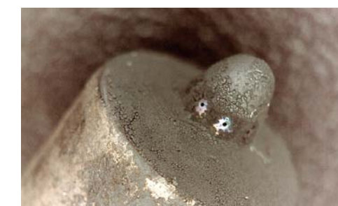
KOŃCÓWKA ROZPYLACZA PO CHEMICZNYM OCZYSZCZENIU OKOLIC OTWORÓW
