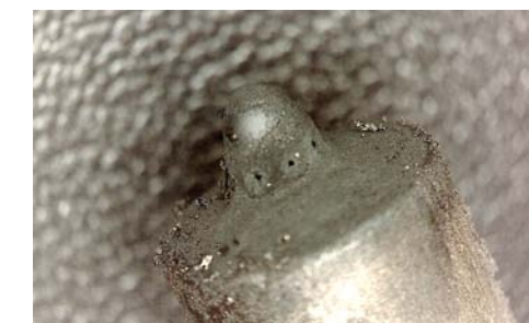
SILNIE ZANIECZYSZCZONA KOŃCÓWKA ROZPYLACZA
