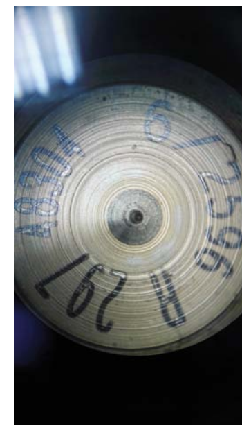
MECHANICZNE USZKODZENIE (ZUŻYCIU) GNIAZDA ZAWORU WTRYSKIWACZA
