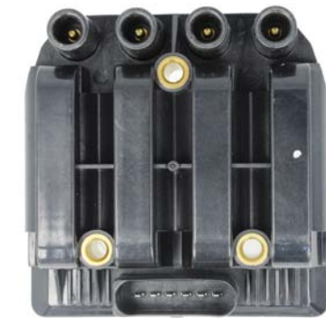
NOWOCZESNA CEWKA WSPÓŁPRACUJĄCA Z NISKONAPIĘCIOWYM (ELEKTRONICZNYM) ROZDZIELACZEM ZAPŁONU I CZTEREMA TRADYCYJNYMI KABLAMI ZAPŁONOWYMI
