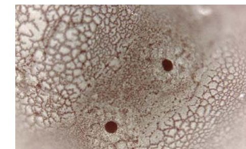
ZANIECZYSZCZONE OSADAMI OTWORY ROZPYLACZA
