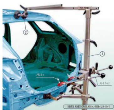
FOT. 6. DZIĘKI TELESKOPOWEJ WIEŻY POŁĄCZONEJ ZE SZTYWNYM SZKIELETEM NADWOZIA POWSTAJE STABILNY UKŁAD UMOŻLIWIĄCY STOSOWANIE RÓŻNYCH SIŁ PROSTUJĄCYCH
