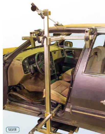
FOT. 8. DŁUGI, POZIOMY WSPORNIK ZESTAWU SMARTPULLER SILVER MA MOŻLIWOŚĆ OBROTU W ZAKRESIE 360°, CO POZWALA PROSTOWAĆ WGNIECENIE NA ROZLEGŁYCH POWIERZCHNIACH POZIOMYCH
