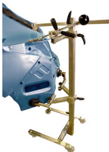
FOT. 7. PRZYRZĄD WRAZ Z NIEUSZKODZONYMI CZĘŚCIAMI NADWOZIA TWORZY SZTYWNY UKŁAD PRZENOSZENIA REAKCJI
