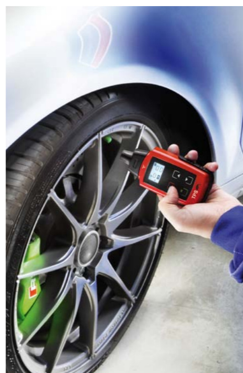
OBŚLUGA CZUJNIKÓW CIŚNIENIA W OGUMIENIU KÓŁ
