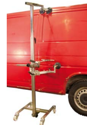
FOT. 4 I 5. PROSTOWANIE WGNIECEN POSZYCIA ZAMIAST WYMIANY JEGO ELEMENTÓW JEST SZCZEGÓLNIIE OPEŁACALNE PRZY NAPRAWACH SAMOCHODÓW DOSTAWCZYCH
