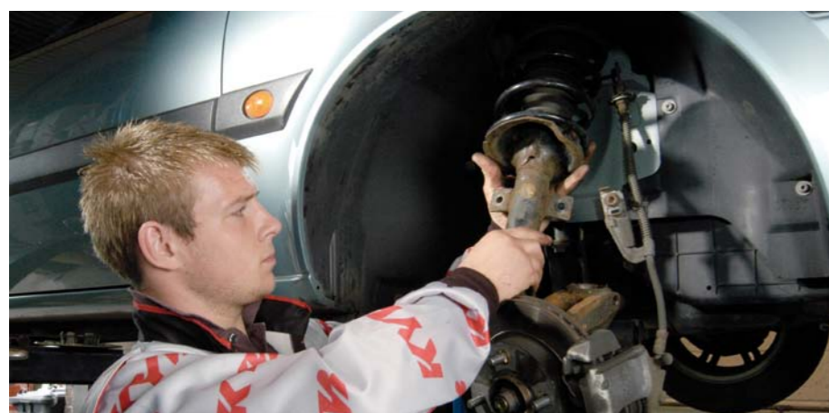
PRZY KOROZYJNYM ZUŻYCIU SPRĘŻYN ZALECA SIĘ WYMIANĘ (PARAMI W OBRĘBIE OSI) KOMPLETNYCH ELEMENTÓW RESORUJĄCO-TŁUMIĄCYCH
