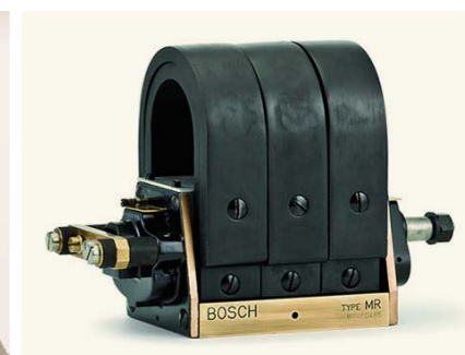
ROBERT BOSCH WRAZ ZE WSPÓŁPRACOWNIKIEM ARNOLDEM ZÄHRINGEREM PO RAZ PIERWSZY Z POWODNIEM ZASTOSOWALI NISKONAPIĘCIOWE MAGNETO W TRÓJKOŁOWCU DE DION-BOUTON
