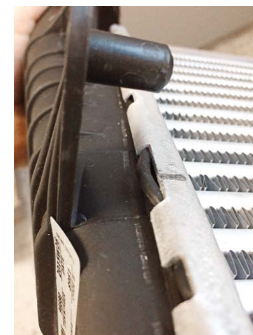
USZKODZENIE PLASTIKOWEGO ZBIORNIKA
