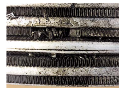
ROZSADZENIE INTERCOOLERA PRZEZ NADMIERNE CIŚNIENIE WEWNĘTRZNE
