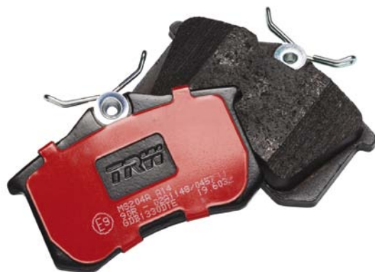
KŁOCKI HAMULCOWE DTEC POSIADAJĄ NAKŁADKĘ ANTYWIBRACYJNĄ, KTÓRA W WIĘKSZOŚCI REFERENCJI MA KOLOR CZERWONY
