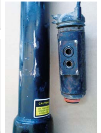
RYS. 4 I 5. W CHIŃSKIM PRODUKCIE KOMORA WYRÓWNAWCZA JEST TYLKO ATRAPĄ TEGO ELEMENTU, PONIEWAŻ NIE MA HYDRAULICZNEGO POŁĄCZENIA Z CYLINDREM ROBOCZYM
