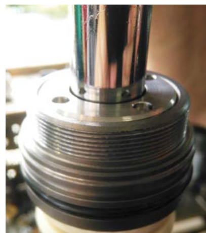
RYS. 11. ZAMKNIĘCIE KORPUSU ŻELIWNĄ PROWADNICĄ TŁOCZYSKA PRODUKOWANA PRZEZ FIRMĘ EMMETEC
