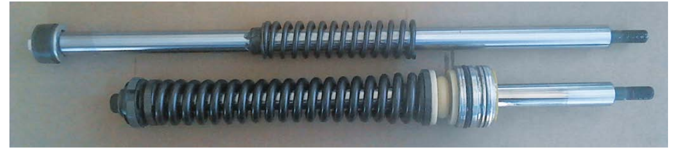
RYS. 1. PORÓWNANIE WEWNĘTRZNYCH CZĘŚCI AMORTYZATORA ORYGINALNEGO (U GÓRY) I JEGO CHIŃSKIEJ PODRÓBKI
