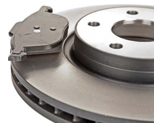
SKUTECZNOŚĆ HAMOWANIA I TRWAŁOŚĆ HAMULCA ZALEŻĄ OD KOMPATYBILNOŚCI OBU WSPÓŁPRACUJĄCYCH ELEMENTÓW CIERNYCH
