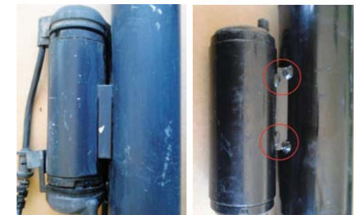
RYS. 6 I 7. ORYGINALNA (Z LEWEJ) I CHIŃSKA KOMORA ELEKTRONICZNEGO STEROWANIA, PO PROSTU PRZYCZEPIONA DO KORPUSU KRÓTKIMI SPAWAMI
