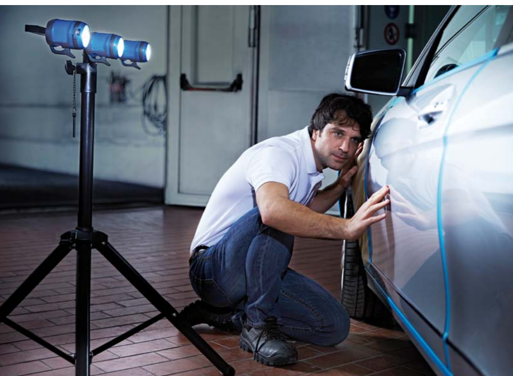
SPRAWDZANIE JEDNORODNOŚCI ODCIENIA LAKIERU ZESTAWEM MDLS CRI
