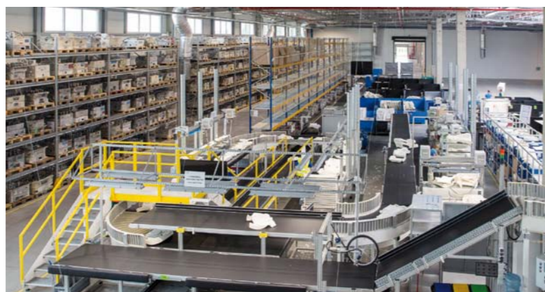
KAŻDA Z LINII OBSŁUGIWANA JEST OSOBNYM TAŚMOCIĄGIEM PRZEMIESZCZAJĄCYM WYJĘTE Z FORM WYROBY PRZEZ DAJSZE FAZY OBRÓBK
