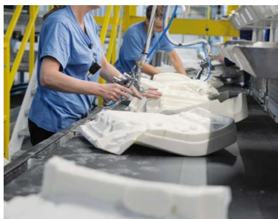
PO WYJĘCIU Z FORM FOTELOWE PODUSZKI PODLEGAJĄ RĘCZNEJ KOREKCE NIEPOŻĄDANYCH NADLEWÓW I PNEUMATYCZNEMU CZYSZCZENIU Z PYŁU
