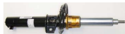
RYS. 6. KOLUMNĄ MCPHERSONA Z AMORTYZATOREM MAGNETOREOLOGICZNYM
