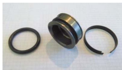
RYS. 10. SEPARATOR ODDZIELAJĄCY PRZESTRZEŃ OLEJOWĄ OD GAZOWEJ
