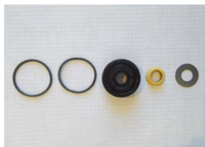
RYS. 7. WEWNĘTRZNE ELEMENTY AMORTYZATORA FIRMY BWI
