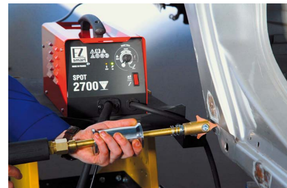
USUWANIE ODKSZTAŁCEŃ METODĄ PANELOWĄ WYMAGA SPECJALNEGO OPRZYRZĄDOWANIA I UMIEJĘTNOŚCI BLACHARZA. LECZ NIE MA NEGATYWNEGO WPŁYWU NA WYTRZYMAŁOŚĆ KONSTRUKCJI NADWOZIA
