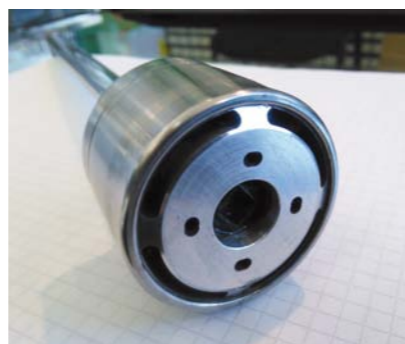
RYS. 9. TŁOK ZE STALE OTWARTYMI KANAŁAMI PRZEPŁYWOWYMI I OTACZAJĄCYM JE SOLENOIDEM
