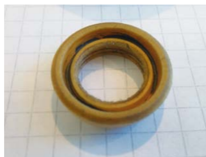
RYS. 8. CHARAKTERYSTYCZNE ZUŻYCIĘ ODRZUTNIKA OLEJU WYSTĘPUJE JUŻ PO NIEWIELKIM PRZEBIEGU POJAZDU
