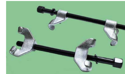
RYS. 3. KOMPLET NAPINACZY ZWOJOWYCH SPRĘŻYN ZAWIESZEŃ
