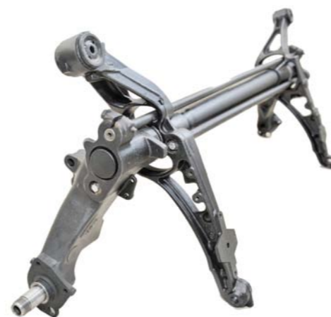
ZAMOCOWANIE DRAŻKA STABILIZUJĄCEGO W GNIAZDACH OBU WAHACZY
