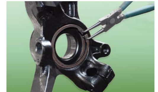
RYS. 16. WYJMOWANIE SPRĘŻYSTEGO PIERŚCENIA ZABEZPIECZAJĄCEGO WCISKOWO OSADZONE ŁOŻYSKO KOŁA
