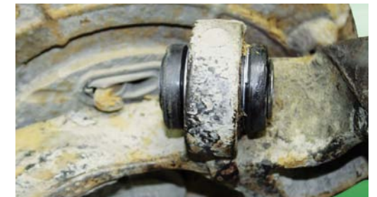
RYS. 14. PRAWIDŁOWE OSADZENIE TULEI GUMOWEJ W CYLINDRYCZNYM GNIEŹDZIE
