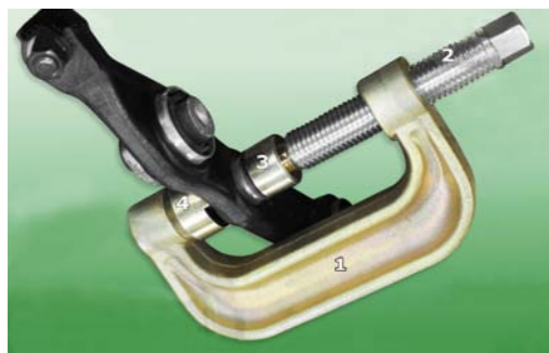
RYS. 9. KABŁĄKOWY WYCISKACZ SWORZNI Z GNIAZD CYLINDRYCZNYCH (1 - KABŁĄK, 2 - ŚRUBA DOCISKOWA, 3 - ADAPTERY)
