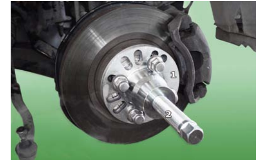
RYS. 15. UNIERSALNY ŚCIĄGACZ DO PIAST PRZEDNICH KÓŁ NAPĘDZANYCH
