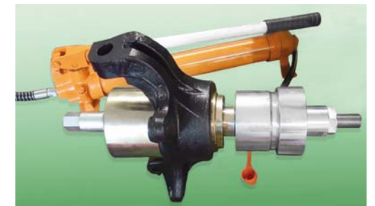
RYS. 17. WYCISKANIE ŁOŻYSKA ZE ZWROTNICY ZA POMOCĄ PRZENOŚNEJ PRASY HYDRAULICZNEJ
