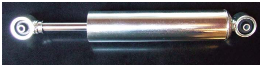
AMORTYZATOR SKONSTRUOWANY INDYWIDUALNIE Z ELEMENTÓW ZESTAWU EMMETEC
