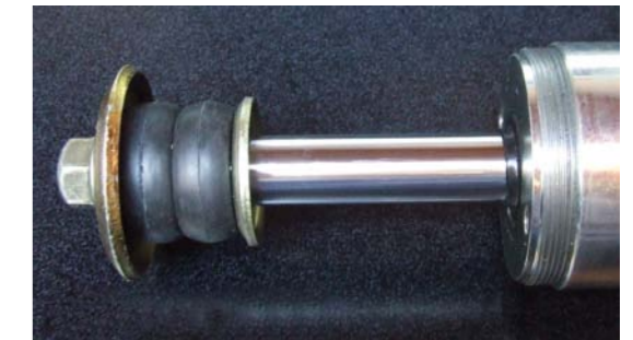
ZAMKNIĘCIE ZMODYFIKOWANEGO AMORTYZATORA WEWNĘTRZNYM PIERŚCIENIEM GWINTOWANYM
