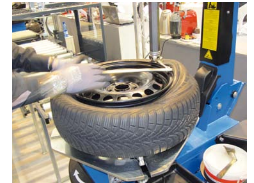
DEMONTOWANE KOŁO PRZESUWANE JEST PO ROLKACH ZE ZBIJAKA NA DOWOLNĄ MONTAŻOWNICĘ (TU MODEL WYMAGAJĄCY POMOCY TRADYCYJNEJ ŁYZKI)
