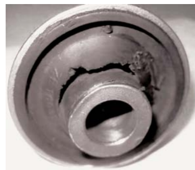
ZNISZCZENIE WARSTWY ELASTOMEROWEJ W POZIOMEJ TULEI WAHACZA
