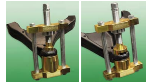
RYS. 11. UŻYCIE ADAPTERÓW I RĘCZNEJ PRASY DO WYCISKANIA (Z LEWEJ) I WCISKANIA (Z PRAWEJ) SWORZNI KULOWEGO
