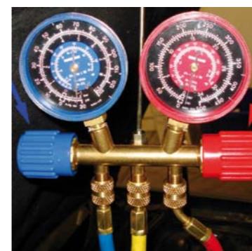
ZESTAW OPRZYRZĄDOWANIA DO CIŚNIENIOWEGO BADANIA SZCZELNOŚCI UKŁADU KLIMATYZACJI
