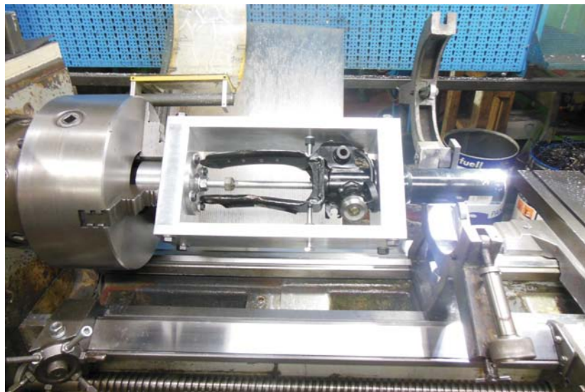
RYS. 8. OPRZYRĄDOWANIE TOKARKI NIEZBĘDNE DO WYKONANIA WEWNĘTRZNEGO GWINTU W RURZE AMORTYZATORA
