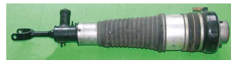
RYS. 6. AMORTYZATOR SYSTEMU ECDC MARKI MONROE
