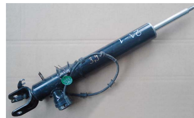
RYS. 5. AMORTYZATOR SYSTEMU ECDC PRODUKOWANY PRZEZ FIRME ZF
