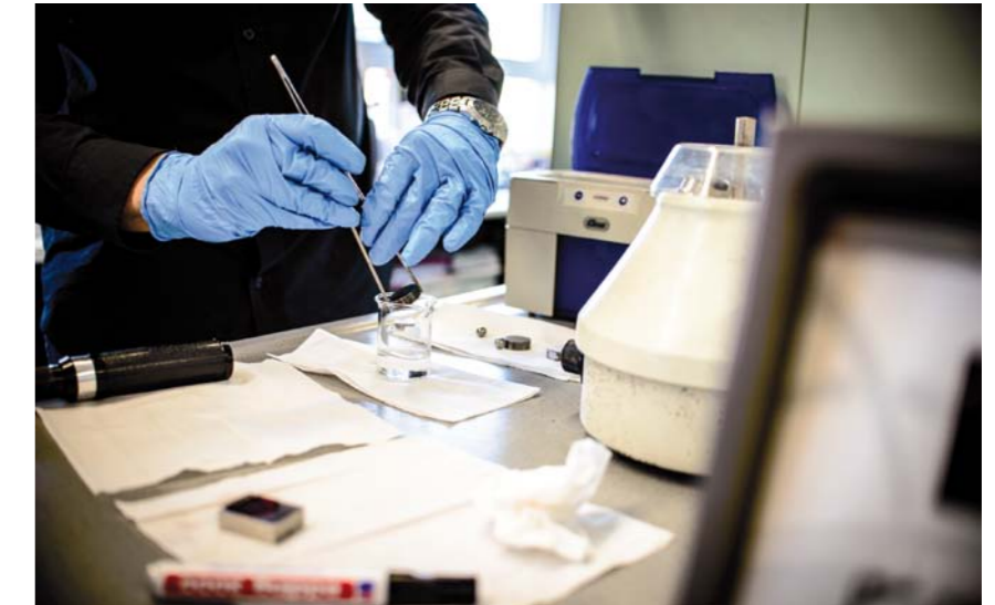
LABORATORYJNY TEST WŁAŚCIWOŚCI SMARNYCH BAZY OLEJOWEJ PRZEZ JEJ POŁĄCZENIEM Z DODATKAMI
