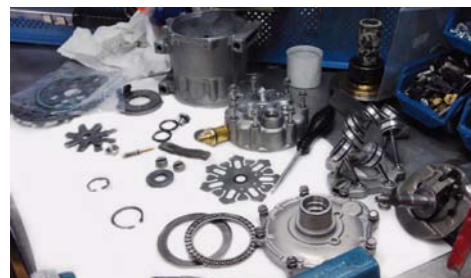
ROZBIÓRKA I SKŁADANIE SPRĘŻARKI POWINNY SIĘ ODBYWAĆ W WARUNKACH STERYLNEJ CZYSTOŚCI
