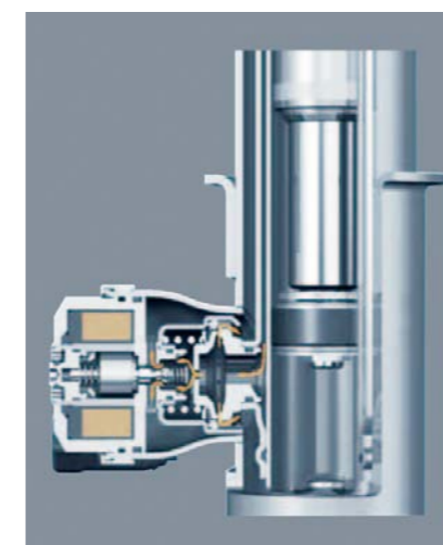
RYS. 4. USYTUOWANIE I PRZEKRÓJ ZAWORU ELEKTROMAGNETYCZNEGO W SYSTEMIE ECDC
