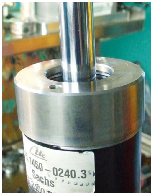
RYS. 9. ZAMKNIĘCIE ZREGENEROWANEGO AMORTYZATORA NASADKĄ ZEWNĘTRZNĄ
