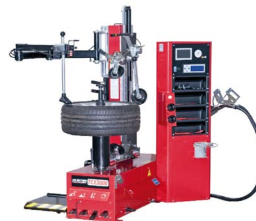
MONTAŻOWNICA Z UCHWYTEM WRZECIONOWYM, ZBIJAKIEM ROLKOWYM I WYPOSAŻENIEM DO OPON NISKOPROFILOWYCH ORAZ RUNFLAT (KAT. IX)
