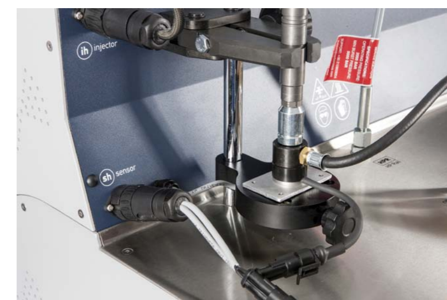
CZUJNIK RSP ZAMOCOWANY NA TESTOWANYM WTRYSKIWACZY CR
