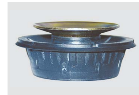
HAŁASY DOBIEGAJĄCE Z GÓRNYCH ZAMOCOWAŃ KOLUMNY MCPHERSONA TO POWAŻNE OSTRZEŻENIE O NIEDOPUSZCZALNYCH ZMIANACH GEOMETRII USTAWIENIA PRZEDNICH KÓŁ
