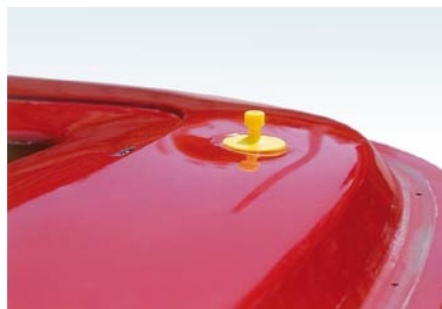
PRZYKLEJENIE POJEDYNCZEGO ZACZEPU NA DNIĘ WGNIECENIA
