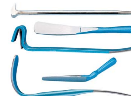
ŁYŻKI DO DŹWIGNIOWEGO WYPYCHANIA WGNIECIEŃ OD STRONY WEWNĘTRZNEJ POSZYCIA
