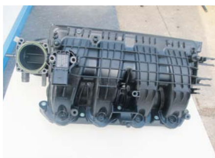
KOLEKTOR DOLOTOWY WYKONANY ZE SPECJALNEGO TWORZYWA ULTRAMID
