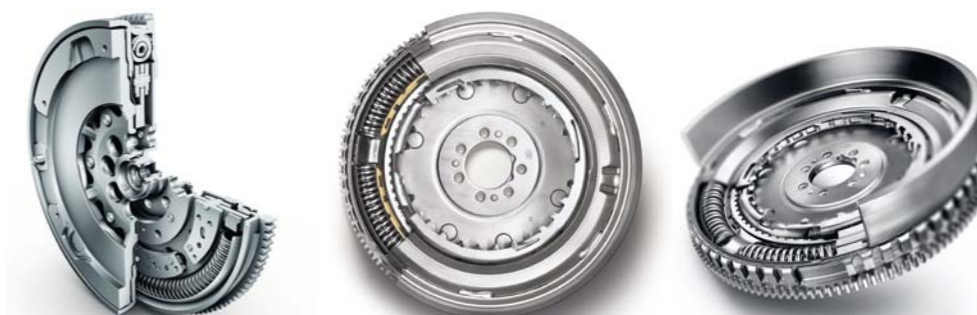
PRZEKOJE ZMONTOWANYCH DWUMASOWYCH KÓŁ ZAMACHOWYCH
