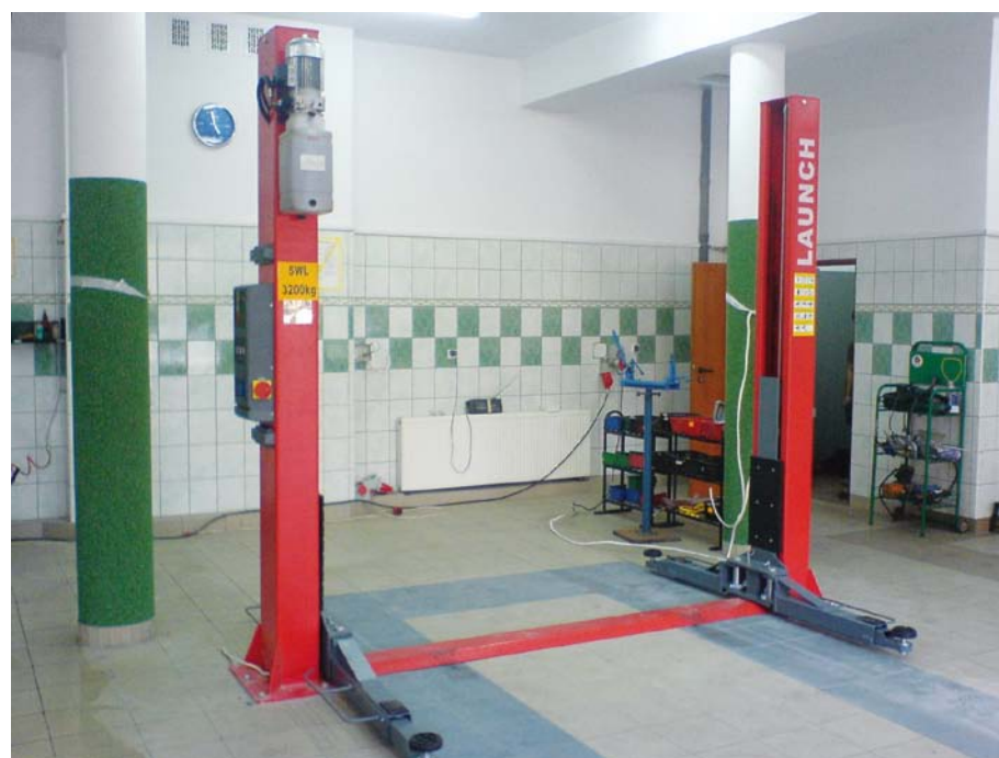
NAJBARDZIEJ UNIWERSALNĄ GRUPĄ PODNOŚNIKÓW SĄ KONSTRUKCJE DWUKOLUMNOWE
