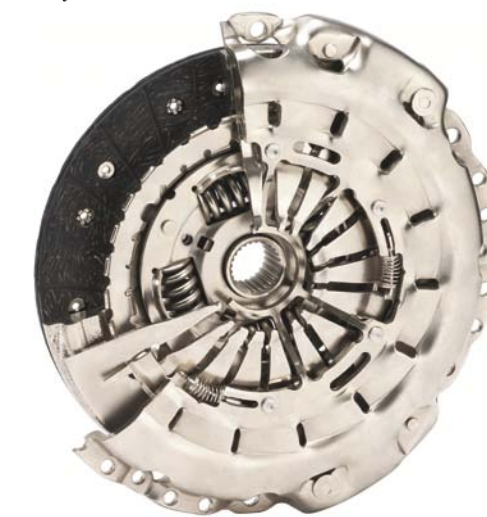
DOCISK SPRZĘGŁA Z SAMOREGULACJĄ (SAC) KONSTRUKCJI FIRMY LUK
