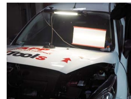
LAMPA CIENIOWA UJAWNIA NIEPOŻĄDANE WYPUKŁOŚCI I ZAGŁĘBIENIA W POWIERZCHNI BLACH
