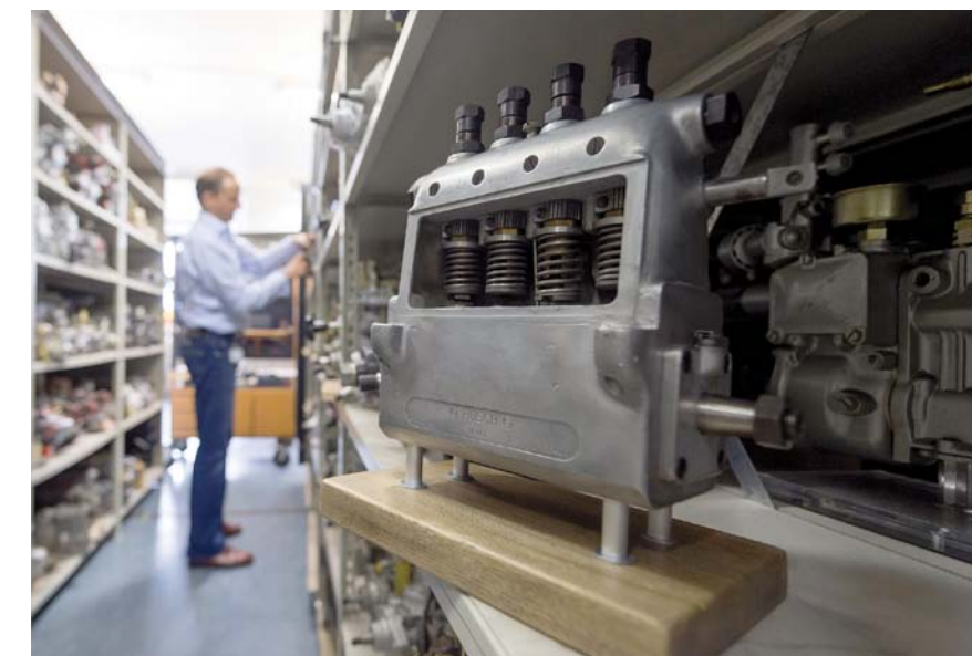
WYPRODUKOWANA W 1927 ROKU POMPA WTRYSKOWA PE4 DO POJAZDÓW UŻYTKOWYCH Z SILNIKIEM DIESLA
