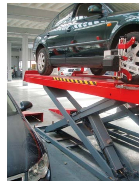
NOŻYCOWA KONSTRUKCJA NAJAZDOWEGO PODNOŚNIKA DIAGNOSTYCZNEGO
