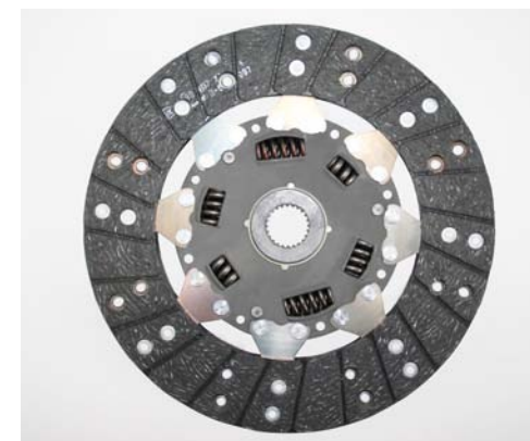
TARCZA SPRZĘGŁA Z TŁUMIKAMI DRGAŃ SKRĘTNYCH
