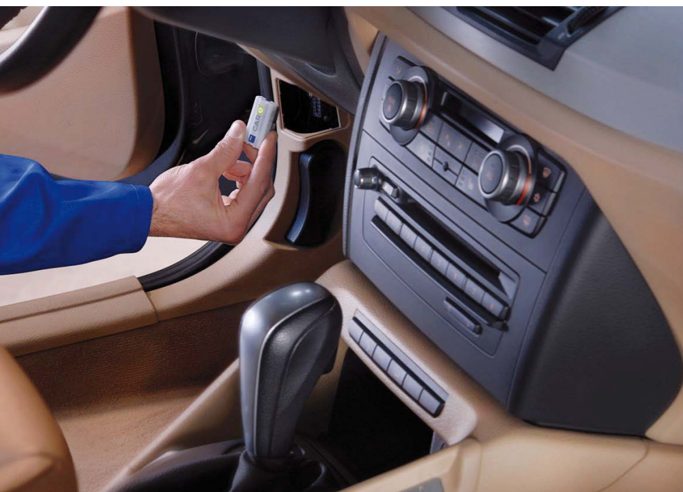
MINIATUROWY MODUŁ KOMUNIKACYJNY POBIERA I EMITUJE WSZYSTKIE DANE Z GNIAZDA OBD
