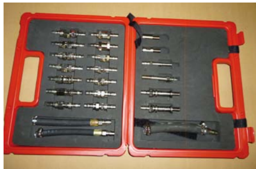
ZESTAW ADAPTERÓW STANOWIĄCY STANDARDOWE WYPOSAŻENIE URZĄDZENIA SERWISOWEGO
