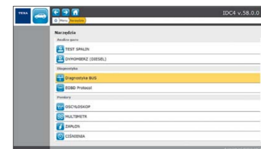
FOT. 7. ZAKŁADKA DO WYKONYWANIA DIAGNOSTYKI SIECI KOMUNIKACYJNEJ CAN – PROGRAM TEXA IDC4E, URZĄDZENIE UNIPROBE FIRMY TEXA
