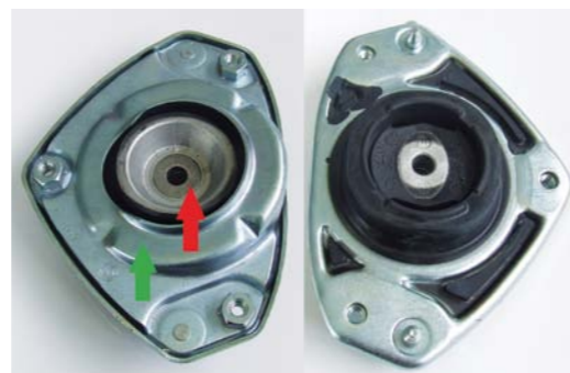
RYS. 10. W PRZYPADKU WSPORNIKA GUMOWO-METALOWEGO SIŁA AMORTYZATORA KONCENTRUJE SIĘ W ŚRODKU (CZERWONA STRZAŁKA), A SIŁA SPRĘŻYNY – NA BRZEGACH ELEMENTU (ZIELONA STRZAŁKA)
