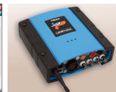
FOT. 7. ZAKŁADKA DO WYKONYWANIA DIAGNOSTYKI SIECI KOMUNIKACYJNEJ CAN – PROGRAM TEXA IDC4E, URZĄDZENIE UNIPROBE FIRMY TEXA
