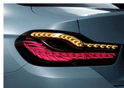
TECHNOLOGIA OLED W TYLNYCH LAMPACH BMW
