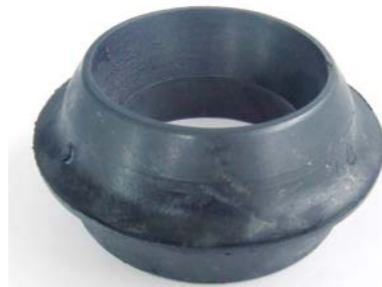
RYS. 9. GUMOWY WSPORNIK Z METALOWYM RDZENIEM ROZDZIELA PUNKTY PRZYŁOŻENIA SIŁ SPRĘŻYNY I AMORTYZATORA
