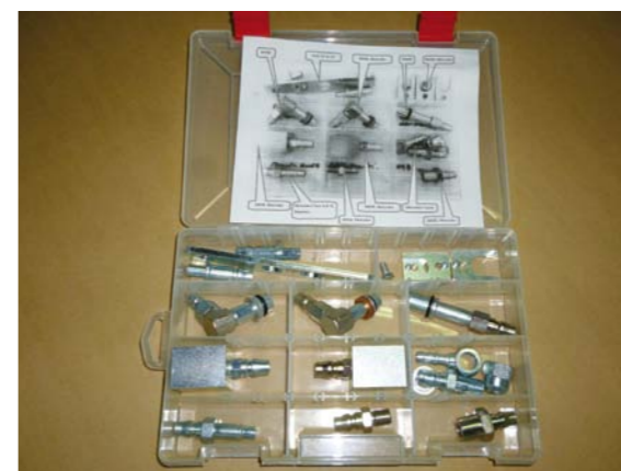
DODATKOWE ZESTAWY ADAPTERÓW UMOŻLIWIĄCE W SUMIE SERWISOWANIE WSZYSTKICH OBECNIE UŻYTKOWANYCH AUTOMATYCZNYCH SKRZYŃ BIEGÓW
