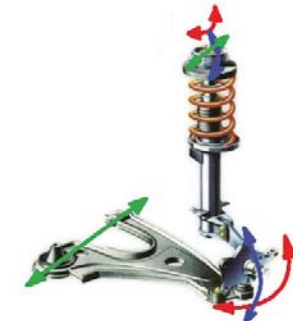
RYŚ. 6. PIASTA KOŁA W ZAWIESZENIU MCPHERSON MOŻE WYKONYWAĆ RUCH DO PRZODU I DO TYŁU (PRZYSPIESZENIE I HAMOWANIE), DO GÓRY I W DÓŁ (TOCZENIE) ORAZ OBRACAĆ SIĘ WOKOŁ OSI ZWROTNICZY (SKRĘT KOŁA), CZYLI POŁĄCZENIE AMORTYZATORA Z PODWOZIEM MUSI BYĆ PODATNE W WYMIENIONYCH KIERUNKACH
