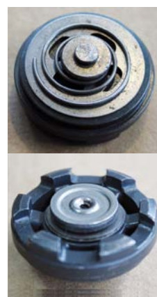
RYS. 15. ORYGINALNE ZAWORY DENNE SĄ Z REGUŁY FABRYCZNIE PLOMBOWANE
