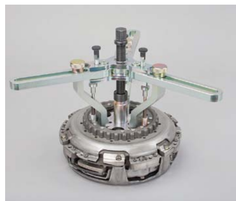
FOT. 11. NOWE SPRĘGŁO PRZYGOTOWANE DO MONTAŻU
