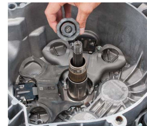
FOT. 7. KOŁNIERZE SPRĘŻYN ZWROTNYCH I OTWORY DŹWIGNI SĄ DO SIEBIE PASOWANE FABRYCZNIE
