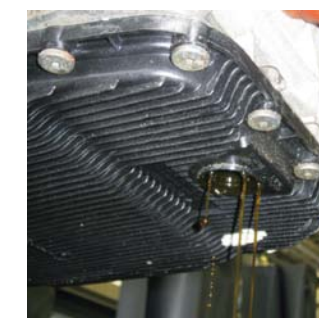
GRAWITACYJNE OPRÓŻNIENIE MISKI OLEJOWEJ SKRZYNI AUTOMATYCZNEJ
