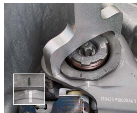
FOT. 9. SPECJALNY KLUCZ DO USTAWIANIA SPRĘŻYN ZGODNIE ZE ZNAKAMI
