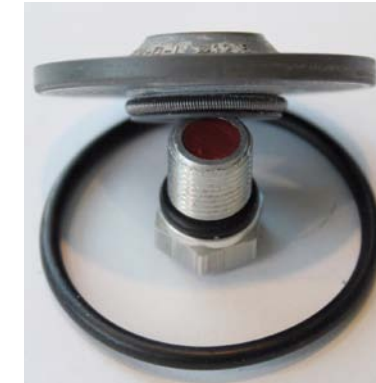
RYS. 7. USZCZELNIENIE TYPU TOP GUN FIRMY EMMETEC O SZERSZYM PIERSCIENIU DOCISKANYM DO TŁOCZYSKA OBLIWOWĄ SPRĘŻYNĄ DO ROZMIARÓW KONKRETNEGO AMORTYZATORA DAJE SIĘ DOSTOSOWAĆ PRZEZ ROZWIERCENIE GNIAZDA NA TOKARCE
