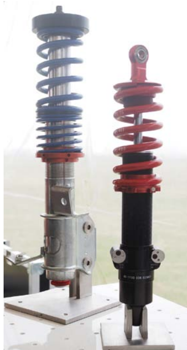
NOWY AMORTYZATOR SACHS (Z LEWEJ) I JEGO TRADYCYJNY ODPOWIEDNIK
