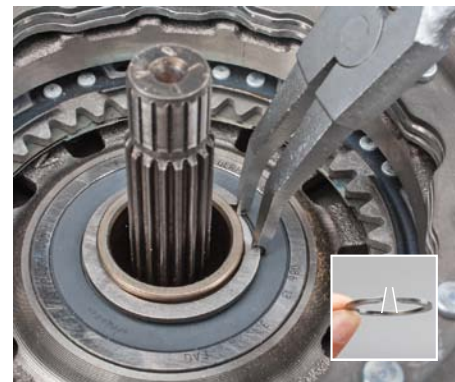
FOT. 13. OPERACJĘ KOŃCZY ZAŁOŻENIE SZCZYPKAMI KL-0192-12 PIERŚCIENIA ZABEZPIECZAJACEGO (ZWĘŻAJĄCĄ SIĘ SZCZELI-NĄ ZAMKA KU GÓRZE)
