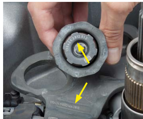
FOT. 8. OZNACZENIA CYFROWE ZAPEWNIĄĄ PRAWIDŁOWE KOMPLETOWANIE SPRĘŻYN Z DŹWIGNIAMI
