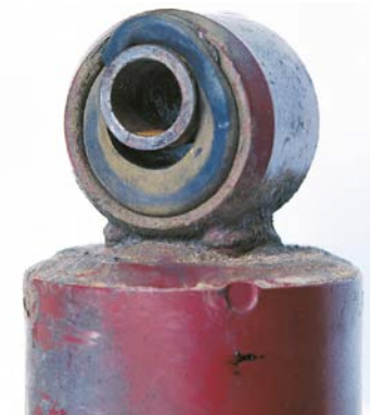
RYS. 5. TAKI STAN OCZKOWEJ KOŃCÓWKI AMORTYZATORA OZNACZA KONIECZNOŚĆ WYMIANY WSZYSTKICH ELEMENTÓW POŁĄCZENIA METALOWO-GUMOWEGO
