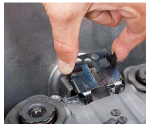
FOT. 10. ZABEZPIECZENIA TRANSPORTOWE MUSZĄ BYĆ USUNIĘTE Z OBU DŹWIGNI
