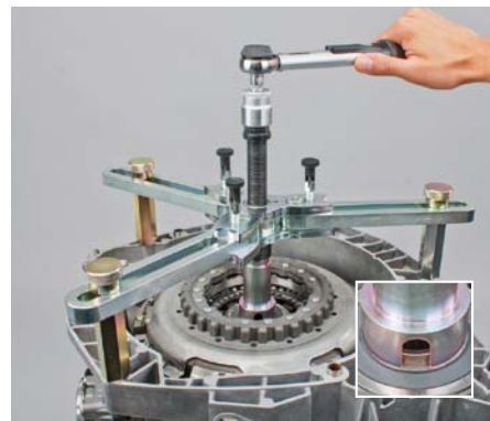
FOT. 12. WZIERNIK TULEI OPOROWEJ DO USTALANIA OSIOWEJ POZYCJI SPRĘGŁA NA WAŁKU
