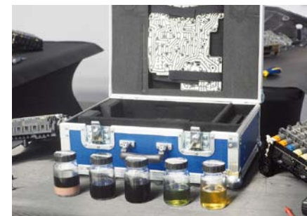
TAK WYGLĄDAJĄ PRÓBKI OLEJU Z AUTOMATYCZNYCH SKRZYŃ BIEGÓW. W WIELU PRZYPADKACH WYMIANA JEST NIEZBĘDNA
