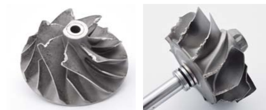
USZKODZENIE ŁOPATEK KOŁA KOMPRESJI I WIRNIKA TURBINY PRZEZ CIAŁA OBCE ZAWARTE W ZASYSANYM POWIETRZU LUB SPALINACH
