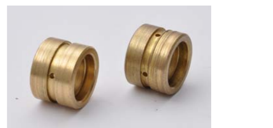
ŁOŻYSKA PORYSOWANE PRZEZ ZANIECZYSZCZONY OLEJ
