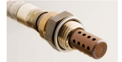
W DOBORZE SOND LAMBDA NIE NALEŻY SIĘ KIEROWAĆ ICH WYGLĄDEM ZEWNĘTRZNYM, GDYŻ POD PODOBNYMI OSŁONAMI KRYJĄ SIĘ ISTOTNE RÓŻNICE
