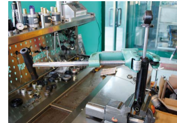
RYS. 5. JEŻELI JEST SIĘ PEWNYM, ŻE MA SIĘ DO CZYNIEŃ Z AMORTYZATOREM DWURUROWYM, MOŻNA PRZYSTĄPIĆ DO JEGO OTWARCIA. NAJPROŚCIEJ PIŁKĄ DO METALU LUB KRĄŻKOWĄ OBCINARKĄ DO RUR, CHRONIĄC OCZY PRZED EWENTUALNYM PRYSKANIEM OLEJU
