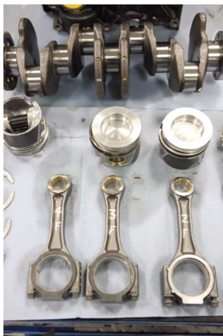
PO ZAKOŃCZENIU TESTOWEGO CYKLU SILNIKI ROZBIERANE SĄ NA POJEDYNCZE ELEMENTY DLA SZCZEGÓLWEJ KONTROLI PROCESÓW ICH ZUŻYCIA
