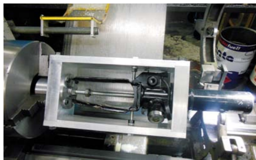
RYS. 9. NIEWSPÓŁOSIOWA KONSTRUKCJA AMORTYZATORA BARDZO UTRUDNIA JEGO WYŚRODKOWANIE NA TOKARCE. ZMUSZAJĄC DO KORZYSTANIA ZE SPECJALNYCH IMAKÓW
