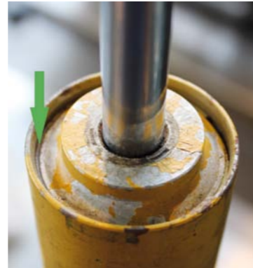
RYS. 1. ZAMKNIĘCIE PIERŚCIENIEM SEEGERA JEST NAJPROSTSZY I NAJPEWNIJSZY ROZWIĄZANIEM DLA AMORTYZATORA JEDNORUROWEGO. PONIEWAŻ SAMO CIŚNIENIE GAZU DOCISKA DO NIEGO PROWADNICĘ
