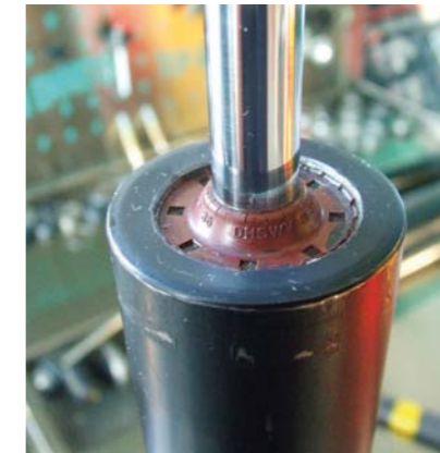
RYS. 4. ZAMKNIĘCIE POPRZECZ WYWINIĘCIE KOŁNIERZA DOMINUJE W AMORTYZATORACH DWURUROWYCH EUROPEJSKICH
