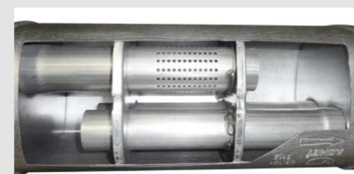
Przekrój tłumika interferencyjnego. Efektywny zakres tłumienia 63-315 Hz
