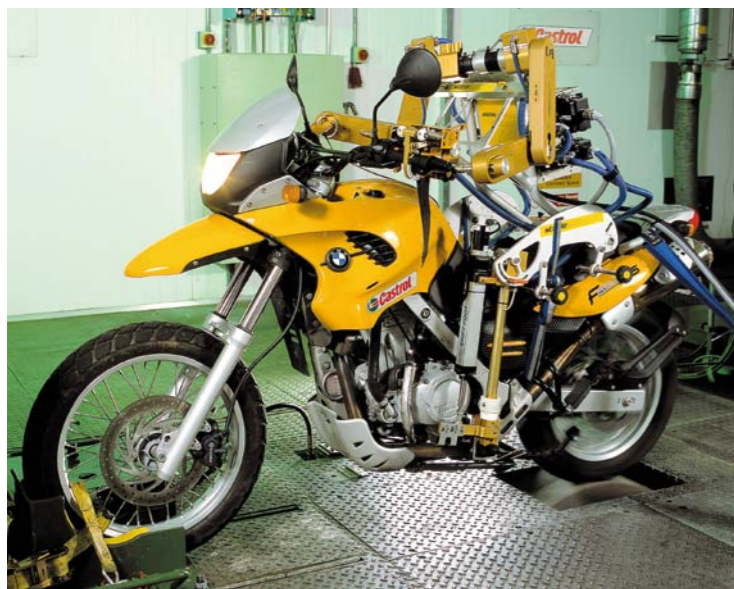
SKOMPUTERYZOWANY ROBOT-MOTOCYKLISTA ODBYWA TESTOWE JAZDY TYLKO NA RÓLKOWYM SYMULATORZE TORU WYŚCIGOWEGO. PONIEWAŻ NA ZWYKŁYCH SZOSACH BUDZIŁBY POPŁOCH WŚRÓD INNYCH UCZESTNIKÓW RUCHU
