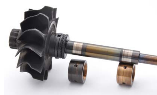
ZANIŻONE PARAMETRY SMAROWANIA PROWADZĄ DO SZKODLIWEGO PRZEGRZEWANIA TURBINY, WAŁKA I JEGO ŁOŻYSKOWAN
