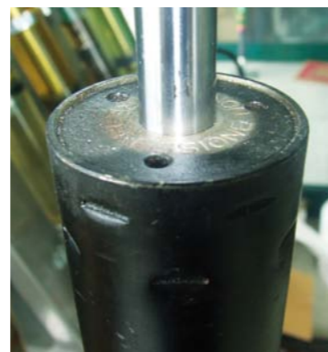
RYS. 2. SPINACZ PROWADNICY NA KORPUSIE AMORTYZATORA JEST TYPOWYM ZAMKNIĘCIEM AMORTYZATORÓW JEDNORUROWYCH PRODUKOWANYCH W DUŻYCH SERIACH. NALEŻY GO OTWIERAĆ, ZACHOWUJĄC ZAWSZE ODPOWIEDNIE ŚRODKI OSTROŻNOŚCI
