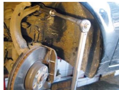
PRAWIDŁOWY MONTAŻ DRĄŻKA KIEROWNICZEGO Z UŻYCIEM KLUCZA DYNAMOMETRYCZNEGO
