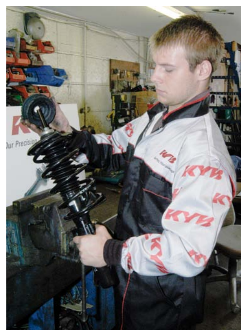
MONTAŻ ELEMENTÓW ZESPOŁU TŁUMIĄCO-RESORUJĄCEGO
