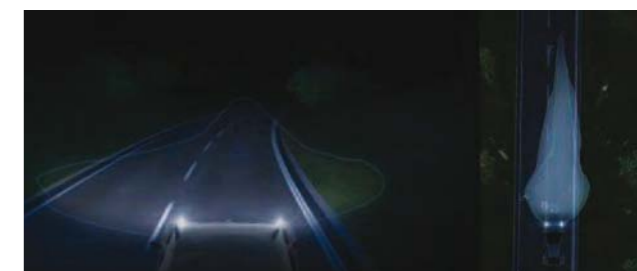
U GÓRY: TRADYCYJNE ŚWIATA MIJANIA, U DOŁU: WZMOCNIŁE DODATKOWYM ŚWIATŁEM AUTOSTRADOWYM
