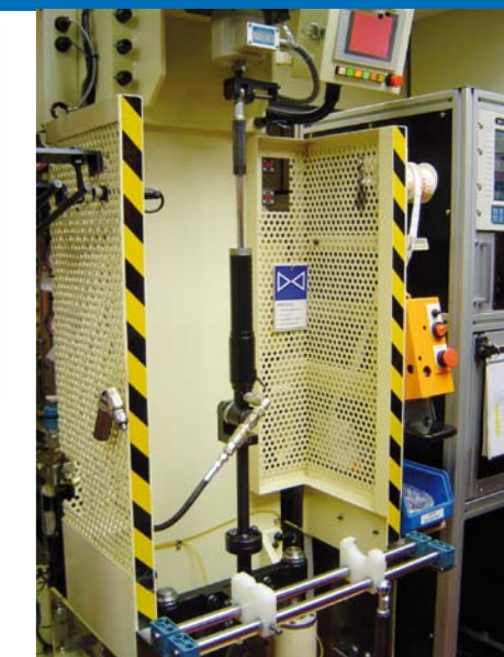
FABRYCZNE STANOWISKO DO BADANIA CHARAKTERYSTYK SIŁ AMORTYZATORÓW
