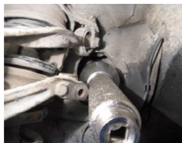
PRZYKŁAD ZASTOSOWANIA SPECJALNEGO KLUCZA DO DEMONTAŻU DRĄŻKA KIEROWNICZEGO
