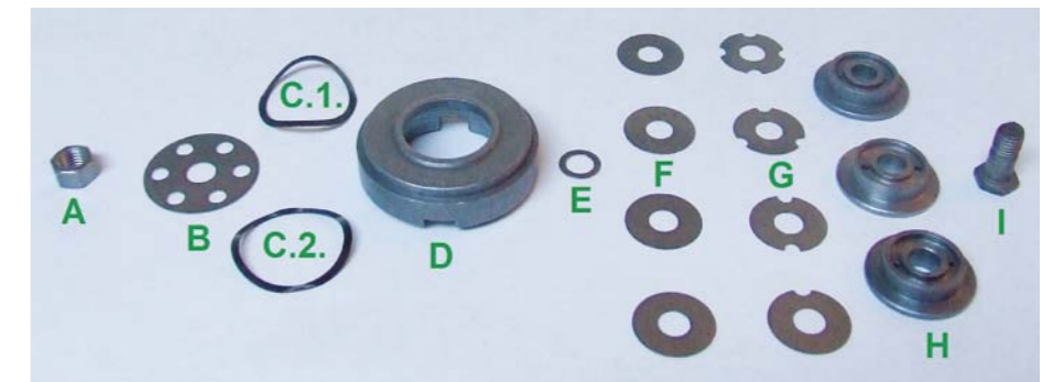
RYS. 5. CZĘŚCI ZAWORU DENNEGO EMMETEC: A. NAKRĘTKA, B. TARCZA OGRANICZAJĄCA PODNOSZENIE BLASZEK, C (1 I 2). SPRĘŻYNY TALERZOWE, D. KORPUS ZAWORU, E. PODKŁADKA, F. BLASZKI PEŁNE DOSTĘPNE W RÓŻNYCH GRUBOŚCIACH, G. KALIBRATORY DOSTĘPNE Z 1, 2, 3 LUB 4 WCIECIAMI, H. TŁOCZEK DOSTĘPNY Z 1, 2 LUB 4 OTWORAMI, KTÓRYCH LICZBĘ MOŻNA ZWIĘKSZYĆ DO 6 LUB 8 DLA ZMNIĘSZENIA SZYBKOCI PRZEPEŁYWU OLEJU
