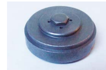
RYS. 4. ZAWÓR DENNY EMMETEC. OLEJ PRZY DOBICIU PRZEPEŁYWA PRZEZ TRZY OTWORÓW WYZNACZAJĄCE CHARAKTERYSTYKĘ AMORTYZATORA PRZY WYSOKICH SZYBKOCIACH RUCHU
