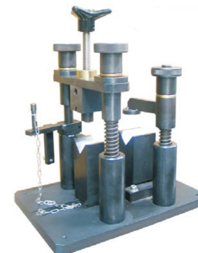
RYS. 13. REGULACJĘ CIŚNIENIA, A ZWŁASZCZA JEGO ZWIĘKSZANIE, MOŻNA WYKONYWAĆ TYLKO W AMORTYZATORZE OSADZONYM W SPECJALNYM STATYWIE
