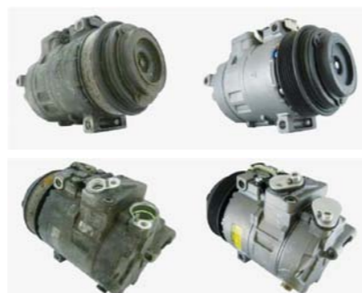
PORÓWNANIE SPRĘŻAREK KLIMATYZACYJNYCH PRZED I PO REGENERACJI
