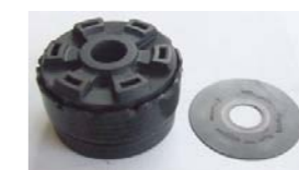
RYS. 10. ZAWÓR ROZCIĄGANIA Z DODATKOWĄ NAKRĘTKĄ BLOKUJĄCĄ TŁOK NA TŁOCZYSKU
