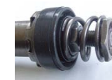
RYS. 10. ZAWÓR ROZCIĄGANIA Z DODATKOWĄ NAKRĘTKĄ BLOKUJĄCĄ TŁOK NA TŁOCZYSKU
