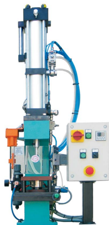
RYŚ. 21. PRASA EMMETEC 99-960 DO MONTAŻU ELASTYCZNYCH PIERŚCIENI TEFLONOWYCH
