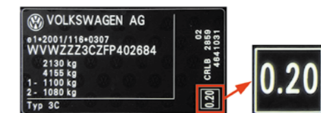
RYS. 8. INFORMACJA O WARTOŚCI ZADYMIENIA SPALIN, ZMIERZONEJ W RAMACH BADAŃ HOMOLOGACYJNYCH WG NORMY EURO 6 DLA NOWEGO SAMOCHODU MARKI VOLKSWAGEN PASSAT VARIANT 2.0 TDI O MOCY 150 KM Z ROKU 2014 (MODEL WPROWADZONY DO SPRZEDAŻY JESIENIĄ 2014 R.)
