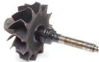
RYS. 1. PIERŚCIEŃ USZCZELNIĄCY ZABLOKOWANY SKOKSOWANYM OLEJEM
