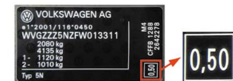
RYS. 7. INFORMACJA O WARTOŚCI ZADYMIENIA SPALIN ZMIERZONEJ W RAMACH BADAŃ HOMOLOGACYJNYCH WG NORMY EURO 5 DLA NOWEGO SAMOCHODU MARKI VOLKSWAGEN TIGUAN 2.0 TDI O MOCY 140 KM Z ROKU 2014 R.
