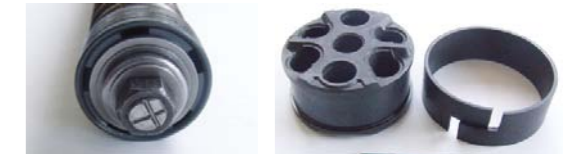
RYS. 11. ZABEZPIECZENIE NAKRĘTKI PRZED SAMOCZYNNYM ODKRĘCANIEM SIĘ PRZEZ ROZKLEPIANIE KOŃCÓWKI TŁOCZYSKA
