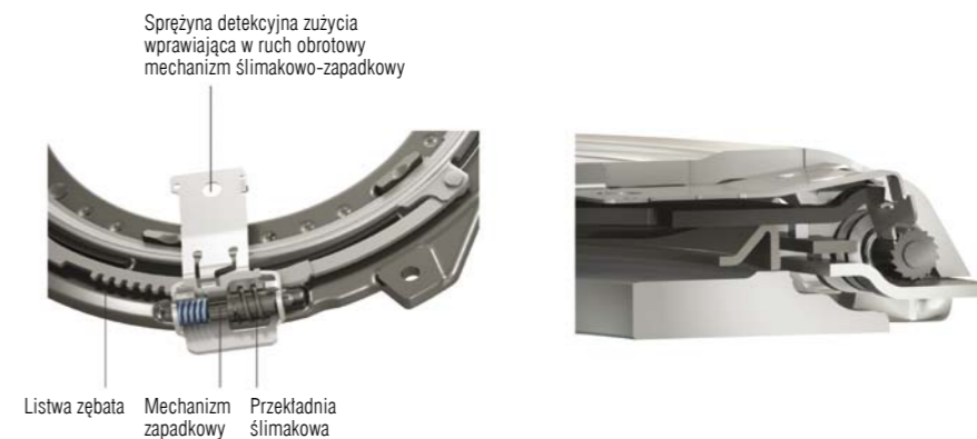
Mechanizm ślimakowo-zapadkowy stosowany w sprzęgłach firmy Valeo
