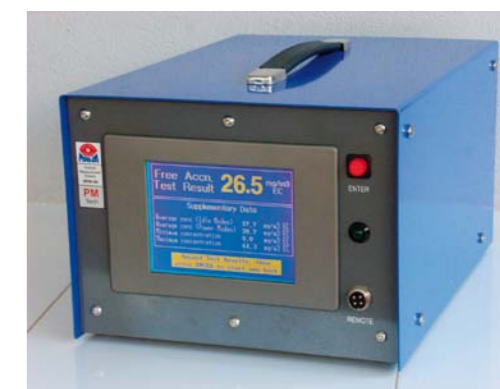
RYS. 2. MAHA MPM-4M – MIERNIK STĘŻENIA CZĄSTEK STAŁYCH W SPALINACH
