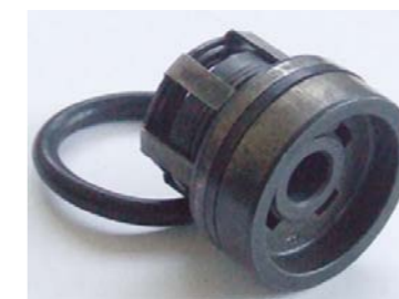
RYS. 4. JEDNOSTRONNY TŁOK PRZEDNIEGO AMORTYZATORA W MODELU VW GOLF IV
