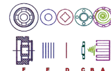
RYS. 5. PRZEKRÓJ TŁOKA JEDNOSTRONNEGO
