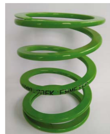
RYS. 8. HELPER EMMETEC DO ŁĄCZENIA ZE SPRĘŻYNĄ GŁÓWNĄ
