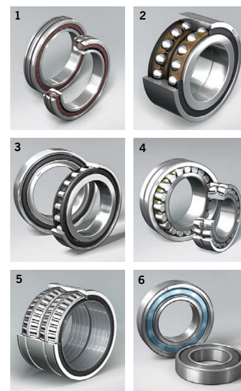
POJEDYNCZE ŁOŻYSKA KULKOWE (1) SĄ ROZWIĄZANIEM OPTYMALNYM PRZY MAŁYCH OBCIĄŻENIACH. PRZY WIĘKSZYCH KORZYSTNIEJSZA JEST KONSTRUKCJA DWURZĘDOWA (2) LUB ROLKOWA (3), A PRZY ZNACZNYCH SIŁACH OSIOWYCH -PODWÓJNIE STOŻKOWA (4 I 5). WE WSZYSTKICH PRZYPADKACH TRWAŁOŚĆ ZALEŻY RÓWNIEŻ OD JAKOŚCI USZCZELNIENIA (6)
