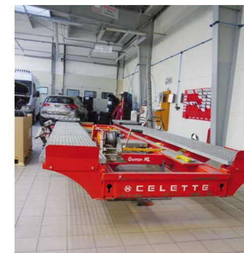
JEDNO ZE STANOWISK MARKI CELETTE PRZEZNACZONYCH DO PROSTOWANIA POWYPADKOWYCH ODKSZTAŁCEŃ NADWOZI
