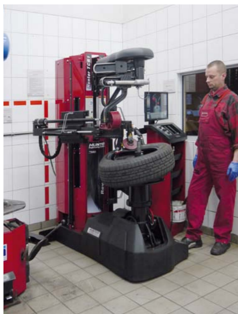
NOWOCZESNA, AUTOMATYCZNA MONTAŻOWNICA DO KÓŁ HUNTER REVOLUTION TCRI MINIMALIZUJE WYSIŁEK FIZYCZNY OPERATORA
