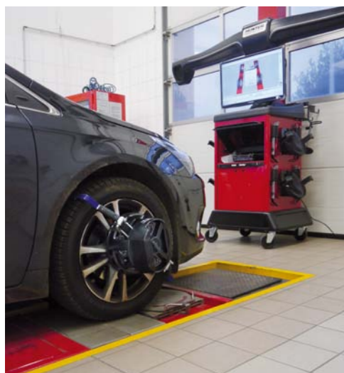
HUNTER QUICKCHECK POZWALA NA SZYBKIE POMIAR GEOMETRII ZAWIESZENIA I JEST CODZIENNIE WYKORZYSTYWANY W SERWISIE TOYOTA UKLEJA
