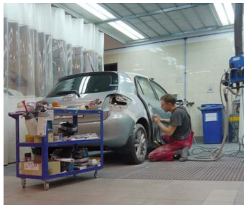
PRZYGOTOWANIE SAMOCHODU DO LAKIEROWANIA PO ZAKOŃCZONEJ NAPRAWIE BLACHARSKIEJ
