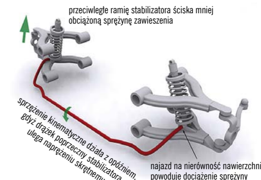
RYS. 18. DZIAŁANIE STABILIZATORA OGRANICZAJĄCE PRZECHYLEY NA ZAKRĘTACH
