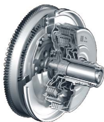
PODWÓJNE SPRZĘGŁO WSPÓŁPRACUJĄCE Z 7-BIEGOWĄ SKRZYNIĄ BIEGÓW
