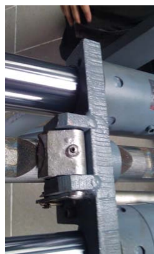
ZAPADKI NA LISTWIE ZĘBATEJ ODBLOKOWYWANE PNEUMATYCZNIE
