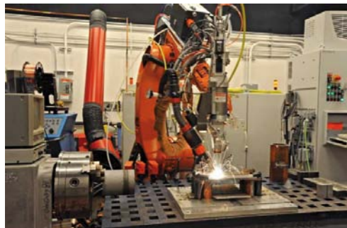
SPAWANIE HYBRYDOWE ALUMINIOWYCH ELEMENTÓW KONSTRUKCJI POJAZDU
