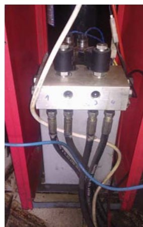
POMPA HYDRAULICZNA Z ZABEZPIEZAJĄCYMI ZAWORAMI JEDNOKIERUNKOWYMI
