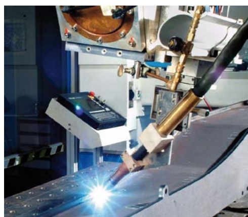
WYSOKOWYDAJNE URZĄDZENIE HYBRYDOWE (LASER+GMA) DO SPAWANIA BELEK WSPORNIKOWYCH KAROSERII
