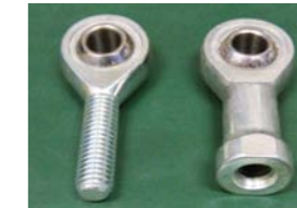
RYS. 10. KOŃCÓWKI WYPUKŁE I WKŁĘSŁE EMMETEC: PRZYKRĘCAJĄC JE LUB ODKRĘCAJĄC NA KORPUSIE AMORTYZATORA LUB NA KOŃCU TRZPIENIA, ZMIENIA SIĘ DŁUGOŚĆ AMORTYZATORA, WSTĘPNY ZAŁADUNEK ELEMENTU ELASTYCZNEGO ORAZ PUŁAP SKOKU W ODBICIU RACZEJ NIŻ W DOBICIU
