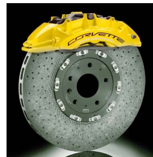
ZACISK EXTREMA W WERSJI OZNACZANEJ KOLEM ŻÓŁTYM W KOMPLECIE Z TARCZĄ CCM JAKO FABRYCZNE WYPOSAŻENIE SAMOCHODU CORVETTE Z07
