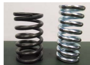
RYS. 5. SPRĘŻYNY OGRANICZAJĄCE SKOK AMORTYZATORA MOŻNA MONTOWAĆ W RÓŻNYCH KOMBINACJACH DLA POPRAWY KOMFORTU LUB STABILNOŚCI JAZDY
