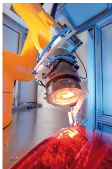
URZĄDZENIE DO SPAWANIA HYBRYDOWEGO TWORZYW SZTUCZNYCH TWINWELD 3D
