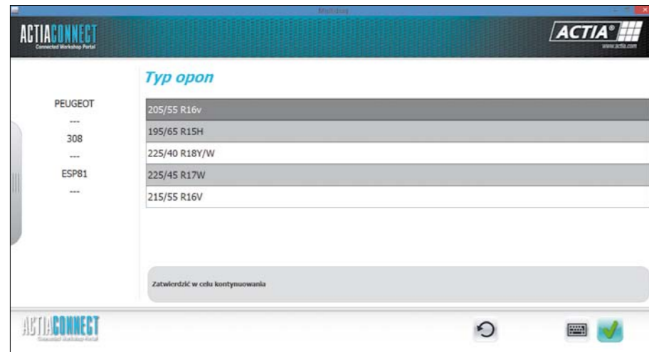
MOŻLIWE ROZMIARY OPON DO KONFIGURACJI ZAPISANE W PAMIĘCI STEROWNIKA ESP [MULTI-DIAG]
