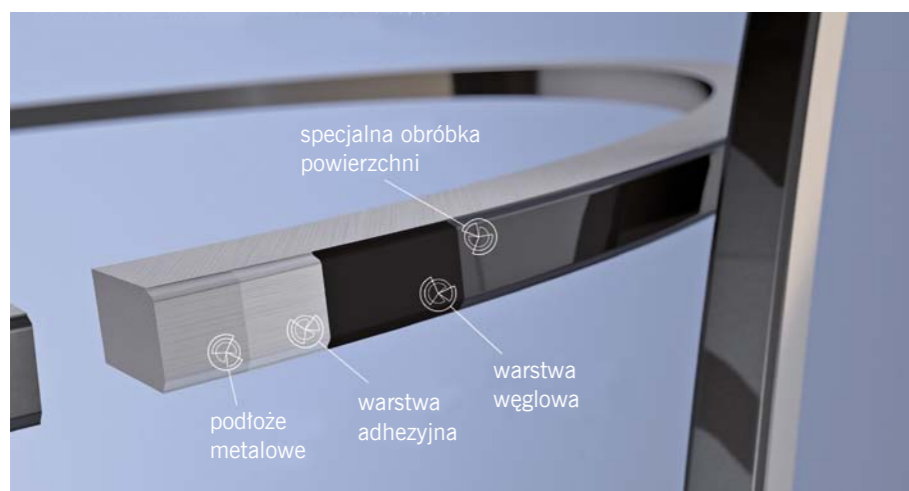
PIERŚCIEŃ TŁOKOWY Z POWŁOKĄ DUROGLIDE® ODZNACZAJĄ SIĘ ZMNIĘSZONYM TARCIEM I ZWIĘKSZONĄ TRWAŁOŚCIĄ
