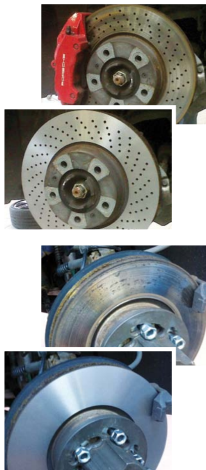
TARCZE HAMULCOWE W PORSCHE 911 I VW SCIROCCO PRZED I PO PRZETOCZENIU
