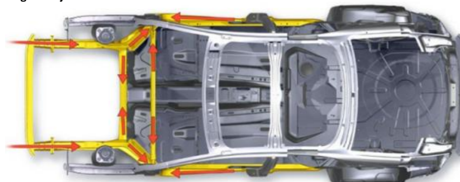
PRZENOSZENIE SIŁ ZDERZENIA W NOWEJ KONSTRUKCJI NADWOZI PRZEZ ZAKRZYWIONE PODŁUŻNICE I POPRZECZNE WZMOCNIENIA PRZEGRODY CZOŁOWEJ
