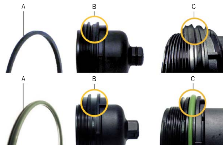
ODMIENNE USZCZELNIENIE FILTRÓW W RÓŻNYCH GENERACJACH SILNIKÓW: U GÓRY Z USZCZELKĄ O PROSTOKĄTNYM PRZEKROJU DO MODELI EURO 4 I EURO 5, U DOŁU Z USZCZELKĄ O PRZEKROJU OKRĄGŁYM DO MODELI EURO 6. A – USZCZELKA, B – PROFIL ROWKA POKRYWY, C – UŁOŻENIE USZCZELKI W ROWKU
