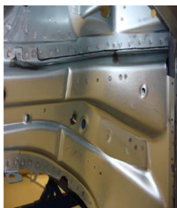
STREFY KONTROLOWANEGO ZGNIOTU W ZMODERNIZOWANYCH PODŁUŻNICACH VOLVO
