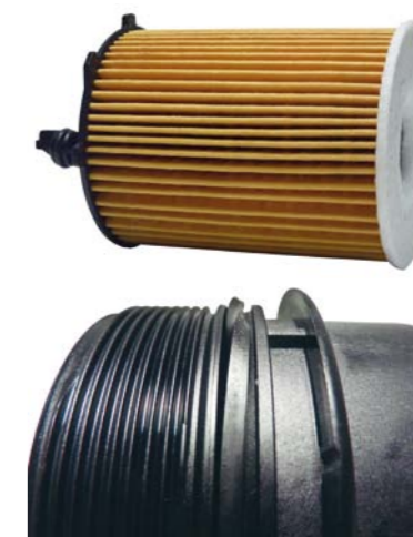
WSZYSTKIE ELASTYCZNE USZCZELNIENIA FILTRA, TAKŻE O-RING TRZPIENIA I KOŃCÓWKA WKŁADU (U GÓRY) MUSZĄ BYĆ PRZED MONTAŻEM POSMAROWANE OLEJEM. STARANNEGO WSTĘPNEGO UŁOŻENIA WYMAGAJĄ CZARNE, PROSTOKĄTNE USZCZELKI POKRYWY, GDYŻ ICH SKRĘCENIE POWODUJE NIESZCZELNOŚĆ
