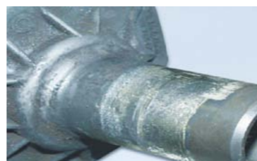
ZUŻYTA TULEJA WAŁKA SPRZĘGŁOWEGO POWODUJE SZARPANIE SPRZĘGŁA LUB/I CIĘŻKIE WYSPRĘŻANIE
