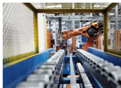
PO NAPEŁNIENIU FORMY KONTROLĘ NAD DALSZYM PRZEBIEGIEM ODLEWNICZEGO PROCESU PRZEJMUJĄ ROBOTY
