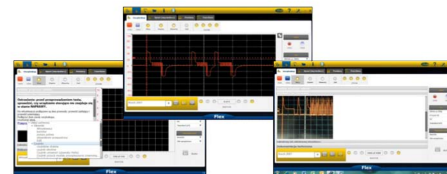
FUNKCJA EASY SCOPE, CZYLI POŁĄCZENIE DIAGNOSTYKI SZEREGOWEJ Z POMIAREM OSCYLOSKOPOWYM
