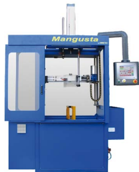
SPECJALISTYCZNE STANOWISKO MANGUSTA UMOŻLIWIA DEMONTAŻ I MONTAŻ WSZELKICH AMORTYZATORÓW, A TAKŻE TOKARSKIE CIĘCIE LUB GWINTOWANIE I SPAWALNICZE ŁĄCZENIE FRAGMENTÓW ICH KORPUSÓW
