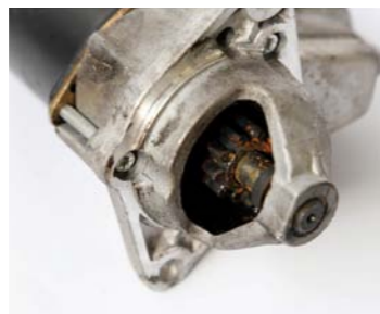
USZKODZENIE KOROZYJNE SPRZĘGŁA JEDNOKIERUNKOWEGO Z POWODU JEGO ZAWILGOCENIA
