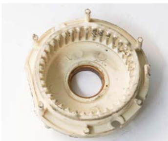
MECHANICZNE USZKODZENIE UZĘBIENIA WĘWNETRZNEGO PRZEKŁADNI PLANETARNEJ
