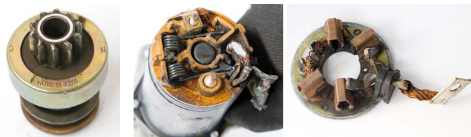
OD LEWEJ: ZUŻYTE KOŁO ZĘBATE (ZĘBNIK) SPRZĘGŁA JEDNOKIERUNKOWEGO, WYPALONE ZŁĄCZA SZCZOTKOTRZYMACZA I ZUŻYTE SZCZOTKI
