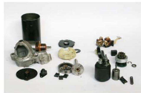
ELEMENTY ROZRUSZNIKA SAMOCHODU MERCEDES SPRINTER
