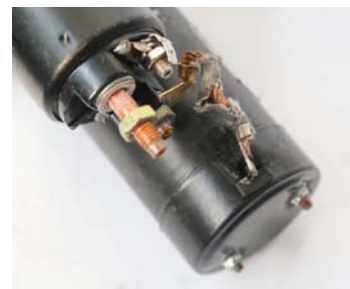
USZKODZENIA SZCZOTKOTRZYMACZA (PRZEGRZANIE, WYTOPIENIE) W ROZRUSZNIKU NADMIERNIE OBCIĄŻONYM
