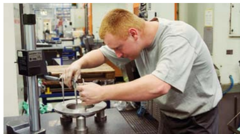
OSTATECZNY KSZTAŁT UZYSKUJE TARCZA PO AUTOMATYCZNEJ OBRÓBCE SKRAWANIEM, A JEJ JAKOŚĆ KONTROLOWANA JEST BARDZO DOKŁADNYM SPRZĘTEM POMIAROWYM
