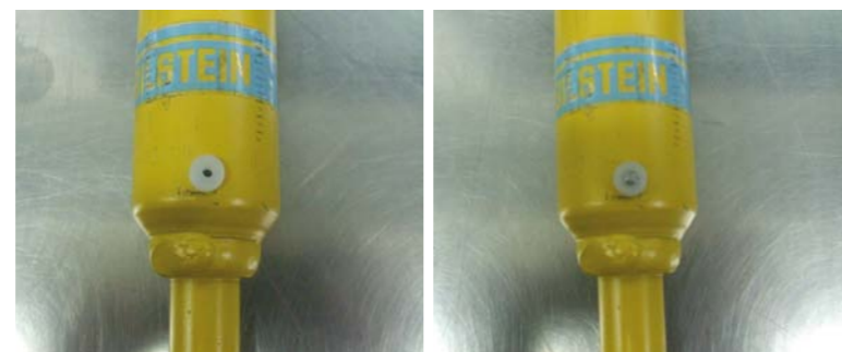
TULEJKA W OTWORZE O ŚREDNICY 4 MM (Z LEWEJ) I KOŁEK WCIŚNIĘTY W TULEJKĘ
