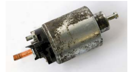
MECHANICZNE USZKODZENIE KOPUŁKI WYŁĄCZNIKA ELEKTROMAGNETYCZNEGO SPOWODOWANE PRZEZ NIEUMIĘTNE ODKRĘCANIE PRZEWODU PRĄDOWEGO
