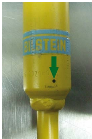
DODATKOWY OTWÓR DO USUNIĘCIA AZOTU, JEGO ŚREDNICĘ 2 MM ZWIĘKSZA SIĘ PÓŹNIEJ DO 4 MM
