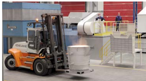
ŻELIWO O PRECYZYJNIE USTALONYM SKŁADZIE PO AUTOMATYCZNYM WYTOPIE TRAFIA DO ODLEWNICZYCH TYGLI
