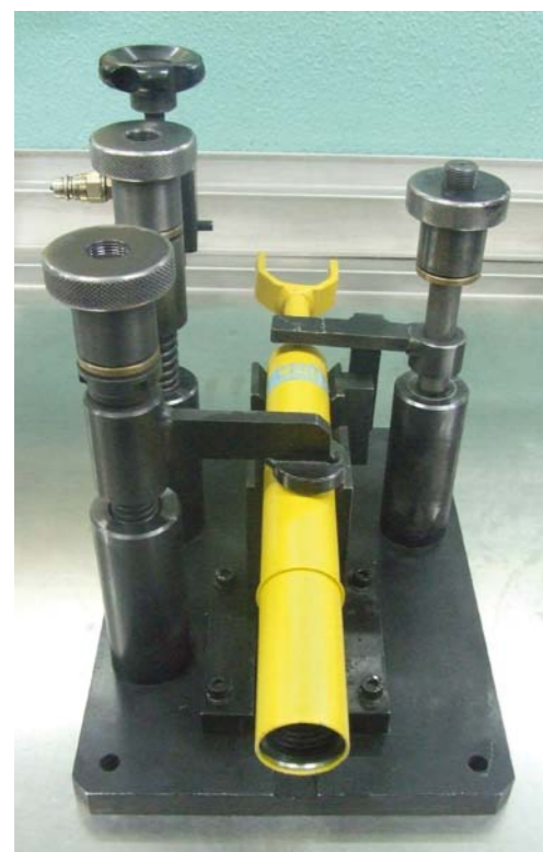
ZAMOCOWANIE KORPUSU AMORTYZATORA W UCHWYPIE NAPEŁNIACZA
