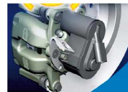
TYLNY ZACISK HAMULCOWY STOSOWANY W SAMOCHODACH VOLKSWAGEN
