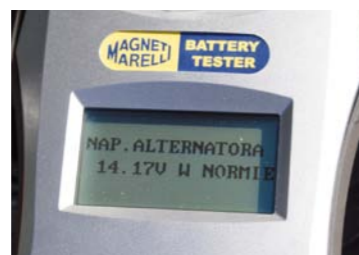
TESTER AKUMULATORA BADAJĄCY JEGO STAN, ZACHOWANIE PODCZAS ROZRUCHU SILNIKA I DZIAŁANIE UKŁADU ŁADOWANIA
