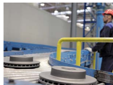
SUROWE ODLEWY OSTUDZONE I OCZYSZCZONE Z FORMIERSKIEGO PIASKU AUTOMATYCZNIE OPUSZCZAJĄ LINIĘ PRODUKCYJNĄ...
