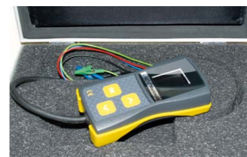
TESTER MASTERALT2 DO BADAŃ ZAAWANSOWANYCH REGULATORÓW NAPIĘCIA
