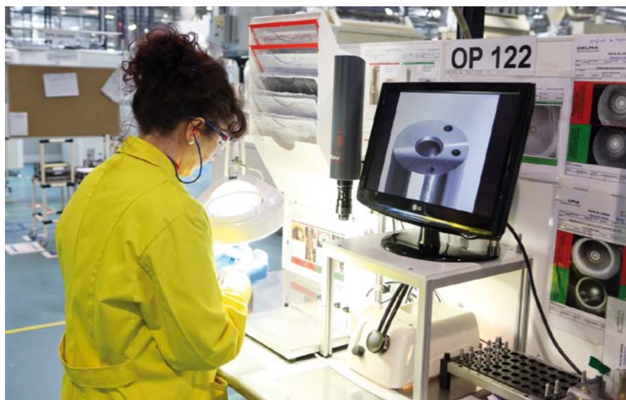
KONTROLA JAKOŚCI WYKONANIA OTWORÓW WIELOKROTNIE CIENSIZYCH OD LUDZKIEGO WŁOSA WYMAGA SPECJALNYCH PRZYRZĄDÓW OPTYCZNYCH I ELEKTRONICZNYCH
