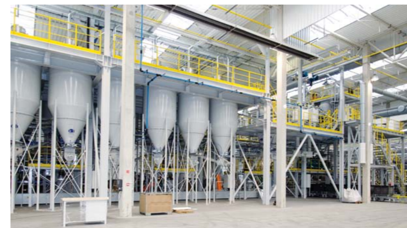
PODSTAWĄ PRODUKCJI FINALNYCH JEST NAJNOWOCZĘSIEJSZA NA ŚWIECIE AUTOMATYCZNA MIESZALNIA MAS CIERNYCH. MOGĄCA REALIZOWAĆ DOWOLNE ICH RECEPTURY
