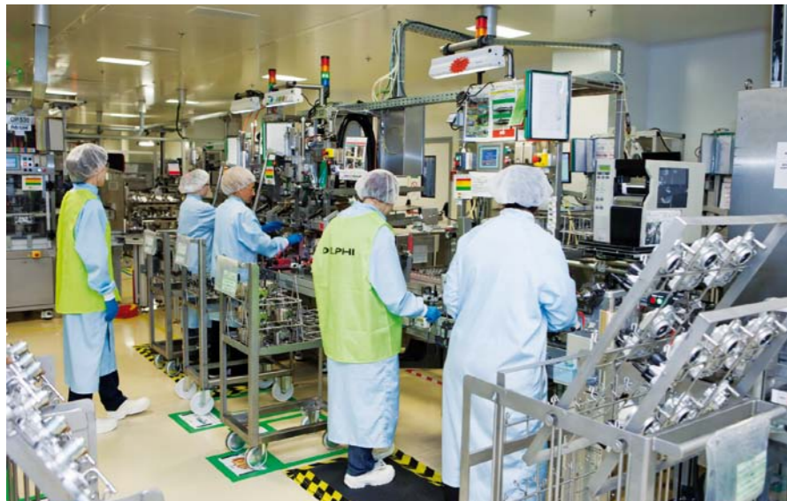
STERYLNA CZYSTOŚĆ TOWARZYSZYĆ MUSI WSZYSTKIM ETAPOM TECHNOLOGICZNEGO CIĄGU. OBOWIĄZUJE WIĘC NIEMAL „CHIRURGICZNA” ROBOCZA ODBIĘ PERSONELU
