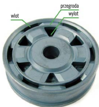
11. TŁOK BILSTEIN Z KRZYŻUJĄCYMI SIĘ KANAŁAMI (ZEWNĘTRZNE PO JEDNEJ STRONIE TŁOKA SĄ WEWNĘTRZNYMI PO DRUGIEJ). ZAWÓR I BY-PASS ROZDZIELA PIERŚCIEŃ, WSPÓŁPRACUJĄCY Z PIERWSZĄ PŁYTKĄ ZAWORU
