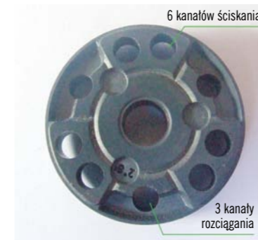
4. TŁOK AMORTYZATORA SACHS Z RÓWNOLEGLYMI KANAŁAMI, Z KTÓRYCH TRZY ZAPEWNIĄJĄ PRZEPŁYW OLEJU PRZY ROZCIĄGANIU, A SZEŚĆ – PRZY ŚCISKANIU
