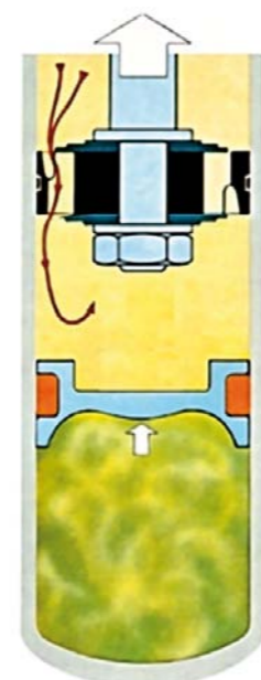
3. W FAZIE ROZCIĄGANIA OLEJ PRZEPŁYWA PRZEZ TŁOK Z GÓRY NA DÓŁ, POWODUJĄC EFEKT TŁUMIENIA, A ROZPRĘŻAJĄCY SIĘ GAZ PRZESUWA TŁOK ROZDZIELAJĄCY
