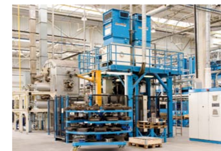
AUTOMATYCZNIE PRZEBIEGA TEŻ FORMOWANIE MASY W RÓZNAJTE MODELE OKŁADZIN LUB KŁOCKÓW, ŁĄCZONYCH NASTĘPNIE ZE STAŁOWYMI PŁYTKAMI NOŚNYMI
