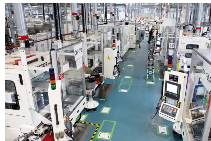
PODZESPOŁY SYSTEMÓW WTRYSKOWYCH PRODUKOWANE SĄ W JASSACH Z MIKRONOWĄ DOKŁADNOŚCIĄ NA AUTOMATYCZNYCH LINIACH OBRÓBKI I MONTAŻU
