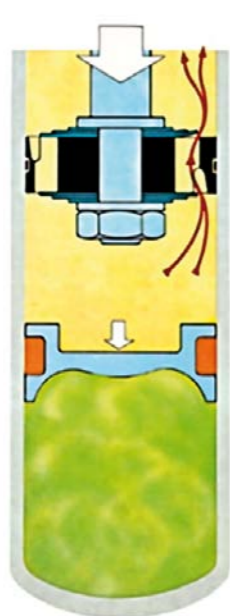
2. W FAZIE ŚCISKANIA OLEJ PRZEPŁYWA PRZEZ TŁOK Z DOŁU DO GÓRY, POWODUJĄC TŁUMIENIE JEGO RUCHU; GAZ ULEGA SPRĘŻANIU
