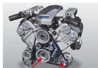
koło elastyczne sprzęgiełko alternatora ELEMENTY TŁUMIĄCE DRGANIA W NAPĘDZIE PASOWYM
