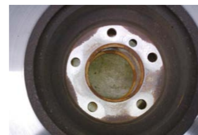
ŚLADY NIEPRAWIDŁOWEJ WSPÓŁPRACY TARCZY HAMULCOWEJ Z PIASTĄ PRZECIĄNIĘTĄ PRZEZ NADMIERNE DOKRĘCANIE ŚRUB MOCUJĄCYCH KOŁO
