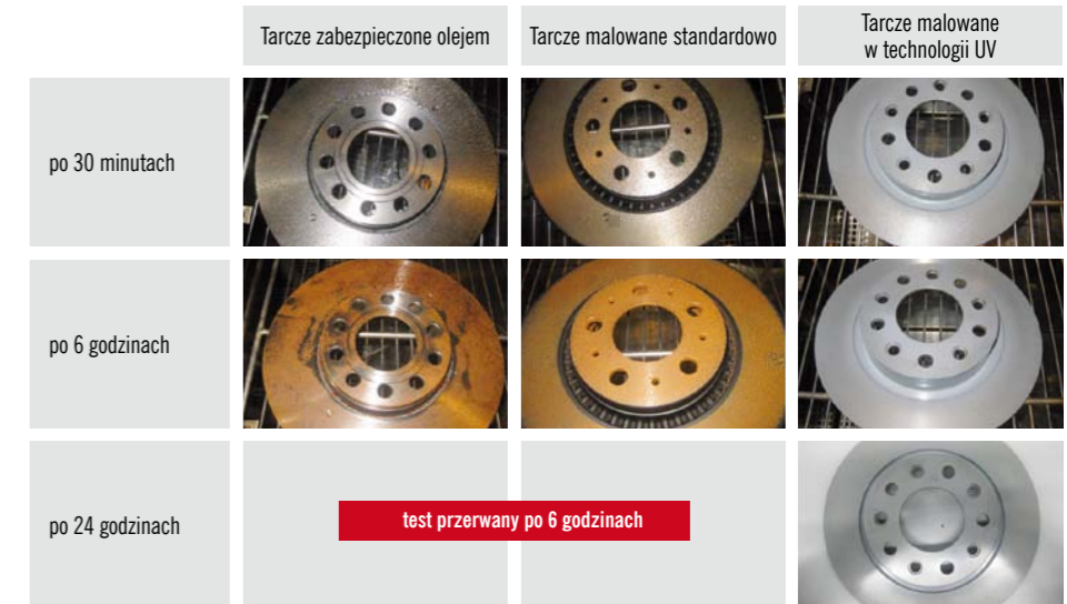
WYNIKI PORÓWNAWCZEGO BADAŃ TRZECH RODZAJÓW TARCZ W KOMORZE Z NATRYSIEM SOLANKOWYM
