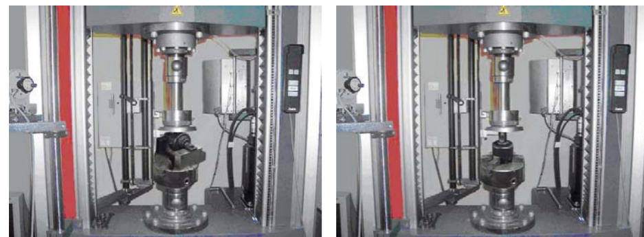
LABORATORYJNE STANOWISKO DO BADANIA WYTRZYMAŁOŚCI TULEI METALOWO-GUMOWEJ, Z LEWEJ – PRZY OBCIĄŻENIU POPRZECZNYM, Z PRAWIEJ – PRZY OSIOWYM
