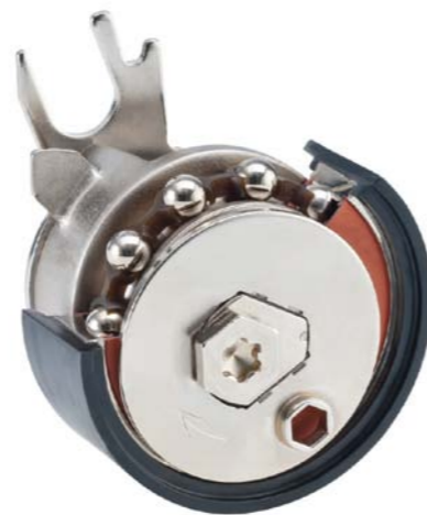
BUDOWA NAPINACZA MECHANICZNEGO. PRZEKRÓJ UWIDACZNI JEDNORZĘDOWE ŁOŻYSKO KULKOWE I OSADZONĄ NA NIM POLIAMIDOWĄ ROLKĘ DOCISKOWĄ
