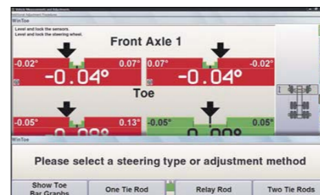
POMIAR ZBIEŻNOŚCI KÓŁ PRZEDNICH OSI ZA POMOCĄ OPATENTOWANEJ PROCEDURY WINTOE
