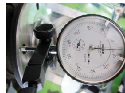
TZW. PRZECIĄNIĘCIE KOŁNIERZA PIASTY WYKRYWA SIĘ ZA POMOCĄ CZUJNIKA ZEGAROWEGO PRZEZ PORÓWNANIE JEGO MINIMALNYCH WSKAZAŃ Z MAKSYMALNYMI. W TYM WYPADKU RÓŻNICA WYNOŚI 0,02 MM I JUŻ MOŻE POWODOWAĆ WADLIWĄ PRACĘ HAMULCA
