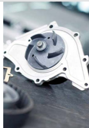
WIDOK ZEWNĘTRZNY POMPY NAPĘDZANEJ PASKIEM ZĘBATYM (Z LEWEJ) I WNĘTRZE KORPUSU Z WIRNIKIEM (U GÓRY)
