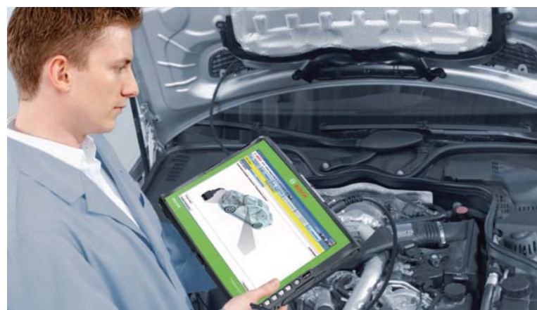
TESTER KTS DIAGNOZUJE KLIMATYZACJĘ NA PODSTAWIE POMIARÓW ELEKTRYCZNYCH WARTOŚCI RZECZYWISTYCH ORAZ ZAPISÓW W PAMIĘCI STEROWNIKÓW
