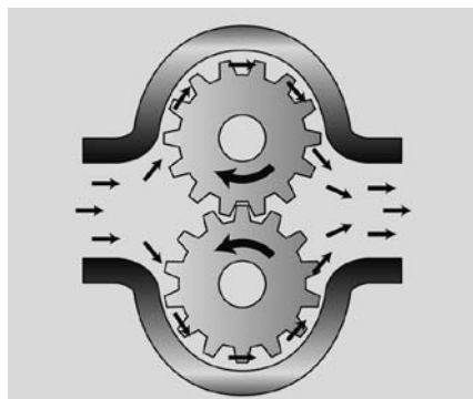
OLEJ O ZBYT NISKIEJ LEPKOŚCI NIE USZCZELNIA DOSTATECZNIE POMPY. CO ZMNIJSZA WYDAJNOŚĆ SMAROWANIA
