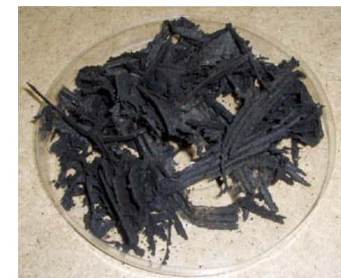
GDY KWAS Z ZASTĘPCZEGO PALIWA PRZENIKA DO OLEJU, WŁÓKNINA MEDIUM FILTRACYJNEGO ULEGA CAŁKOWITEMU ZNISZCZENIU
