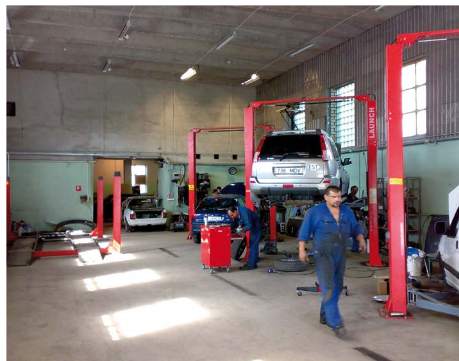
PRZY STOSOWANIU PODNOŚNIKÓW DWUKOLUMNOWYCH Z GÓRNYM POŁĄCZENIEM SYNCHRONIZACYJNYM WYSOKOŚĆ OBSŁUGIWANYCH POJAZDÓW JEST OGRANICZONA
