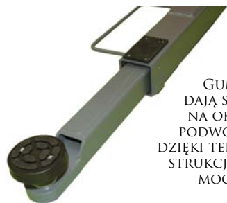
GÓRNE USYTUOWANIE BELKI SYNCHRONIZACYJNEJ PODNOŚNIKA DWUKOLUMNOWEGO POZWALA OBSŁUGIWAĆ SAMOCHODY O DOWOLNIE MAŁYM PRZEŚWICIE PODWOZI
