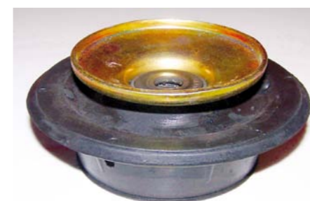
GUMOWA CZĘŚĆ ŁOŻYSKOWANIA ZAPOBIEGAJĄCA PRZENOSZENIU DRGAŃ ZAWIESZENIA NA KONSTRUKCJĘ NOŚNĄ POJAZDU
