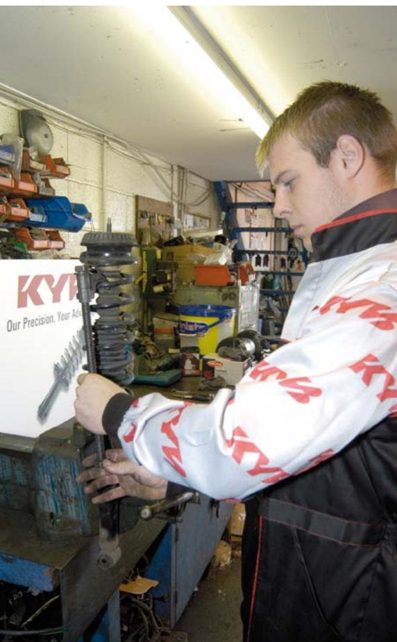
DEMONTAŻ KOLUMNY MCPHERSONA
