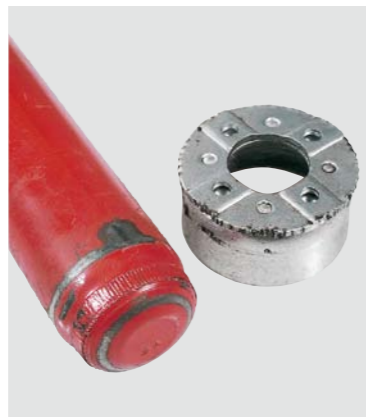
OBTARCIA DOLNEJ CZĘŚCI KOLUMNY MCPHERSONA
