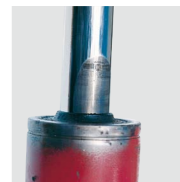
PRZETARTA WARSTWA CHROMU POKRYWAJĄCEGO TŁOCZYSKO
