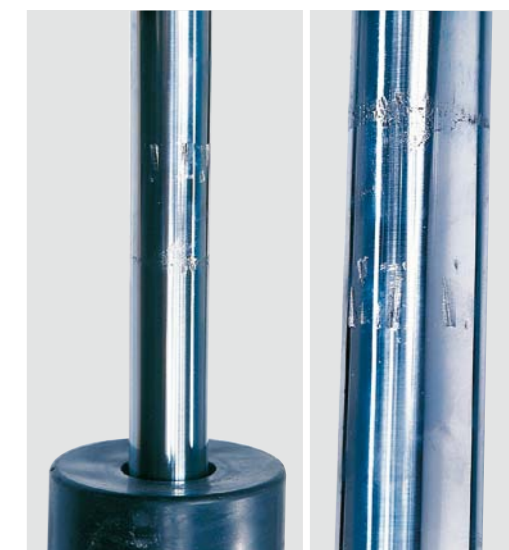
UBYTKI I WŻERY NA GŁADZI TŁOCZYSKA
