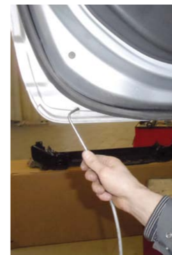
DO PEŁNYCH SZEROKICH PRZESTRZENI (PRZYKŁAD Z LEWEJ) UŻYWA SIĘ KĄTOWEJ KOŃCÓWKI ROZPYLAJĄCEJ Z PORĘCZNYM UCHWYTEM
