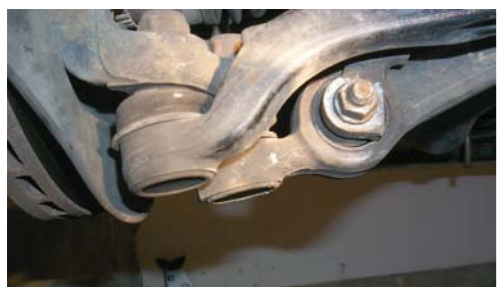
TULEJA METALOWO-GUMOWA OSADZONA W WAHACZU
