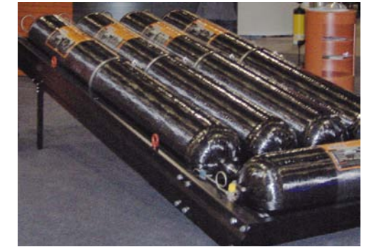
ZBIORNIKI CNG, NAWET TE LŻEJSZE KOMPOZYTYWOWE, NADAJĄ SIĘ RACZEJ DO WIĘKSZYCH SAMOCHODÓW
