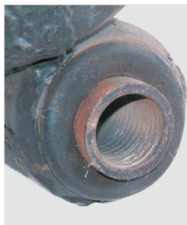
ODCISK GWINTU ŚRUBY WEWNĄTRZ TULEI METALOWO-GUMOWEJ
