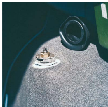
PRZYCZYNA HAŁĄSLIWEJ PRACY GÓRNEGO ZAMOCOWANIA AMORTYZATORA UJAWNIA SIĘ CZĘSTO JUŻ PO ZDJĘCIU OCHRONNEGO KAPTURKA
