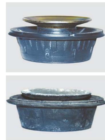
ŁOŻYSKO KOLUMNY MCPHERSONA. U GÓRY: SPRAWNE, U DOŁU: ZUŻYTE
