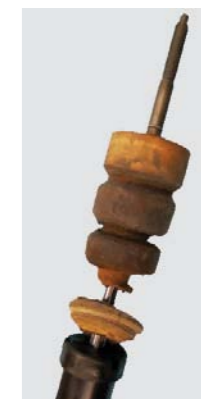
USZKODZONY GUMOWY OD-BOJNIK ŚCISKA- NIA NIE CHRONI AMORTYZATORA PRZED PRZE- CIĄŻENIAMI
