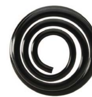
SPRĘŻYNA TYPU MINIBLOCK MA PROGRESYWNĄ CHARAKTERYSTYKĘ DZIĘKI ZMIENNEMU PRZEKROJOWI DRUTU
