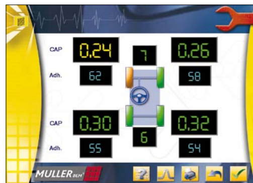
WIDOK EKRANU TESTERA EXPERT BENCH Z WYNIKAMI POMIARU METODĄ EUSAMA ORAZ Z WYKORZYSTANIEM WSPÓŁCZYNNIKA CAP
