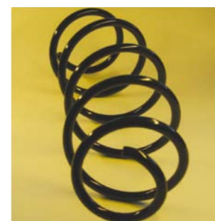
SPRĘŻYNY TYPU SIDE LOAD REDUKUJĄ TARCIE POMIĘDZY TŁO-CZYSKIEM A USZCZELNIACZEM AMORTYZATORA
