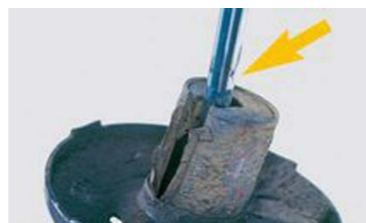
AMORTYZATOR ZNISZCZONY NA SKUTEK ZGIĘCIA TŁOCZYSKA
