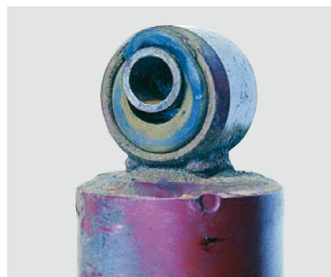
ZUŻYTE I WYBITE TULEJE GUMOWE LUB METALOWO-GUMOWE W UCHWYTACH MOCUJĄCYCH
