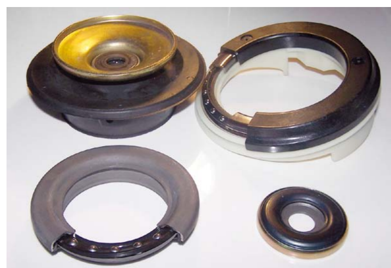
ELEMENTY GÓRNEGO MOCOWANIA AMORTYZATORA PRODUKOWANEGO PRZEZ NTN-SNR (ŁOŻYSKA TOCZNE POKAZANO W PRZEKROJU)
