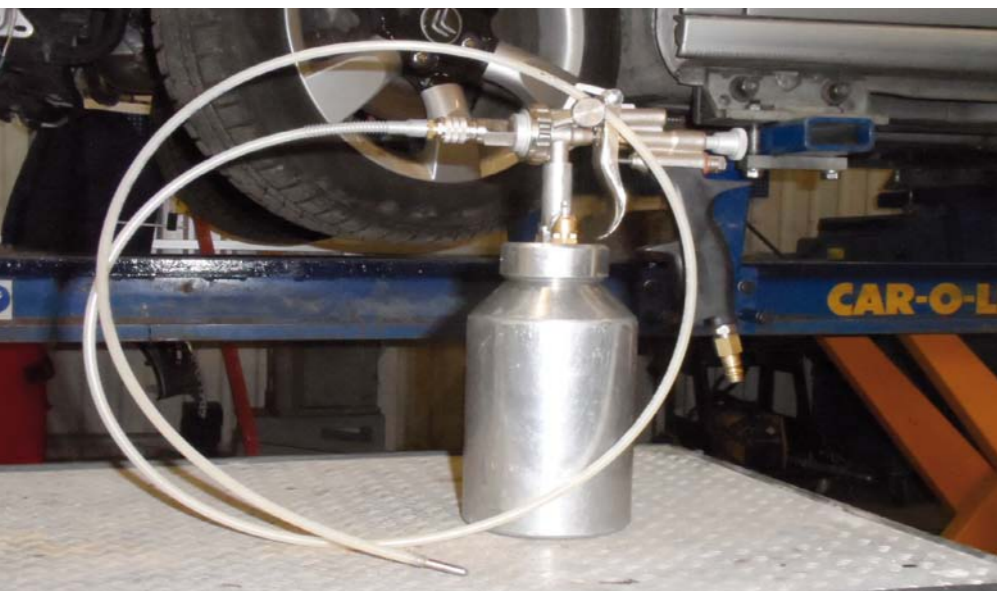
PISTOLET PNEUMATYCZNY DO APLIKACJI ANTYKOROZYJNYCH PREPARATÓW ML. DŁUGI APLIKATOR ELASTYCZNY Z PROSTĄ KOŃCÓWKĄ ROZPYLAJĄCĄ SŁUŻY DO KONSERWACJI WNĘTRZ GŁĘBOKICH WĄSKICH PROFILÓW. NP. PROGÓW (ZDJĘCIE Z PRAWY)
