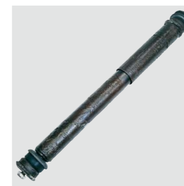
AMORTYZATOR ZANIECZYSZCZONY PREPARATEM DO OCHRONY PODWOZIA
