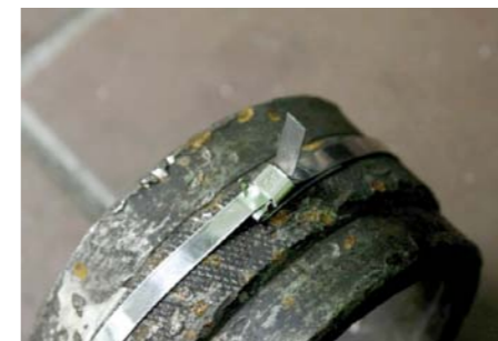
PROSTOPADLE ODGIĘTY KONIEC OPASKI WYMAGA JESZCZE ZAWINIĘCIA NA ZŁĄCZKĘ I ZABEZPIECZENIA ZA POMOCĄ JEJ BOCZNYCH WYPUSTEK
