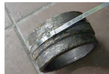
PO OPASANIU DOWOLNEJ KRAWĘDZI GUMOWEJ OSŁONY TAŚMĄ NAPINA SIĘ WSTĘPNIE, PRZECIĄGAJĄC JEJ DRUGI KONIEC PRZEZ SZCZELINĘ ZŁĄCZKI
