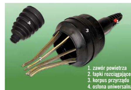
GUMOWĄ OSŁONĘ PRZEGUBU MONTUJE SIĘ SPECJALNYM PRZYRZĄDEM PNEUMATYCZNYM FIRMY TESAM, BEZ NIEGO PRACA JEST UCIAŻLIWA, A JEJ EFEKTY NIEPEWNE
