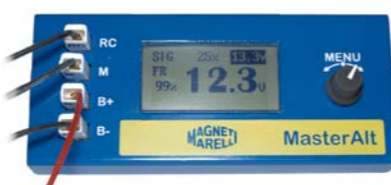
URZĄDZENIE MASTERALT FIRMY MAGNETI MARELLI DO TESTOWANIA REGULATORY NAPIĘCIA
