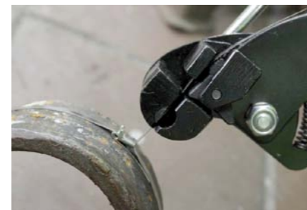
TEN SAM PRZYRZĄD SŁUŻY TEŻ DO ODCINANIA POZOSTAŁEJ CZĘŚCI TAŚMY, KTÓRĄ MOŻNA WYKORZYSTAĆ DO WYKONYWANIA NASTĘPNYCH OPASEK
