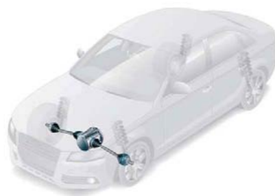
USYTUOWANIE PRZEGUBÓW W STANDARDOWYM WSPÓŁCZESNYM SAMOCHODZIE OSOBOWYM
