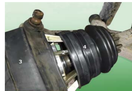
SPUSZCZENIE SPRĘŻONEGO POWIETRZA Z PNEUMATYCZNEGO SIŁOWNIKA POWODZI ZAMKNIĘCIE RAMION I UMOŻLIWIA WYJĘCIE PRZYRZĄDU Z OSŁONY
