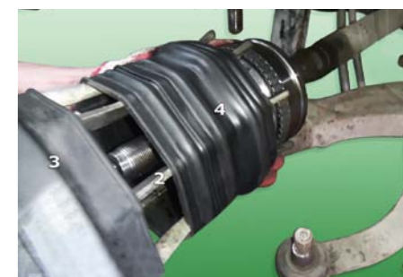
SPRĘŻYSZCIE ROZCIĄGNIĘTA OSŁONA DAJE SIĘ BEZ TRUDU PRZESUNĄĆ PRZEZ ZAMONTOWANY JUŻ PRZEGUB DO SWOJEJ WŁAŚCIWEJ POZYCJI ROBOCZEJ
