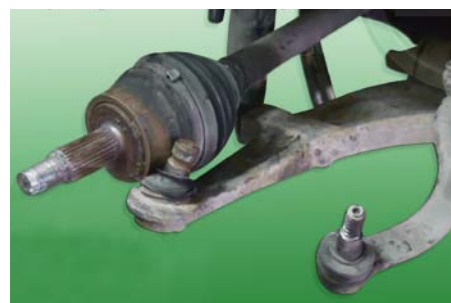
PRZEDNIE ZAWIESZENIE SAMOCHODU I JEGO KOMPLETNA PÓŁOŚ NAPĘDOWA PO WSTĘPNYM PRZYGOTOWANIU DO WYMIANY ZUŻYTEGO PRZEGUBU NA NOWY
