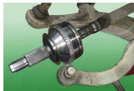
NOWY PRZEGUB OSADZONY NA WIELOWYPUŚCIE WAŁU PÓŁOSI PO JEGO STARANNYM OCZYSZCZENIU ORAZ SPRAWDZENIU STANU WZDŁUŻNYCH ROWKÓW I KARBÓW
