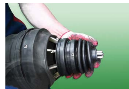
PNEUMATYCZNIE ROZCHYLANE RAMIONA ZNACZNIE ROZCIĄGAJĄ OSŁONĘ, CO DOBRYM PRODUKTEM NIE SZKODZI, A KIEPSKICH I TAK MONTOWAĆ NIE WARTO
