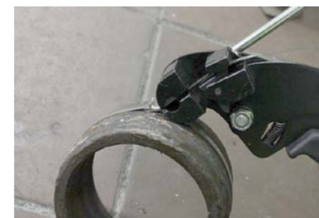
SPECJALNE KLESZCZE NAPRĘŻAJĄ OPASKĘ Z WYMAGANĄ SIŁĄ I RÓWNOCZEŚNIE ZAGINAJĄ JĄ PRZY ZŁĄCZCE POD KĄTEM 90°, ZAMYKAJĄC OBWÓD
