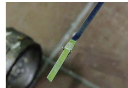
OBIE KRAWĘDZIE OSŁONY MOŻNA MOCOWAĆ CIĘTYMI OPASKAMI ZACISKOWYMI, W SPOSÓB POKAZANY TUTAJ NA ZASTĘPCZYM MODELU
