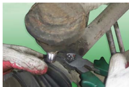
OSŁONĘ GUMOWĄ I ICH OPASKI ZACISKOWE USUWA SIĘ PO ICH PRZECIĘCIU, PONIEWAŻ CZĘŚCI TE W ŻADNYM WYPADKU NIE MOGĄ BYĆ POWTÓRNIE UŻYTE
