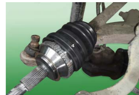
PRZED NASUNIĘCIEM KRAWĘDZI OSŁONY NA KOŁNIERZ PRZEGUBU TRZEBA WPROWADZIĆ DO JEJ WNĘTRZA ODPOWIEDNIĄ ILOŚĆ WŁAŚCIWEGO SMARU
