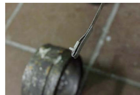
KONIEC UNIwersALNEJ STAŁOWEJ TAŚMY PO WSUNIĘCIU GO W SPECJALNĄ ZŁĄCZKĘ TRZEBA ZAGIĄĆ POD KĄTEM 180° DO WNĘTRZA JEJ KRZYWIZNY
