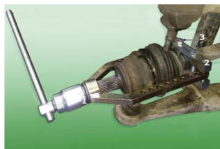
W TEJ KONSTRUKCJI ŚCIĄGACZA ROLĘ ŚRUBY POCIĄGOWEJ PEŁNI Z POWODZENIEM GWINTOWANA KOŃCÓWKĄ PRZEGUBU WRAZ Z JEJ ORYGINALNĄ NAKRĘTKĄ
