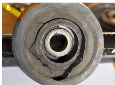
BRAK WSPÓŁOSIOWOŚCI CZĘŚCI PĘKNIĘTEGO TŁUMIKA
