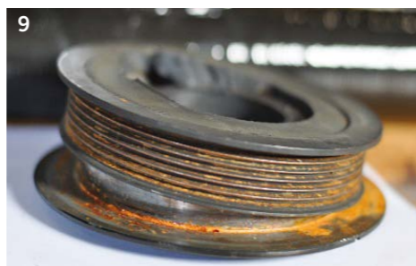
BRAK WSPÓŁOSIOWOŚCI CZĘŚCI PĘKNIĘTEGO TŁUMIKA
