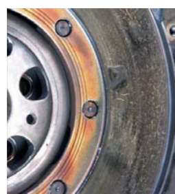
CAŁKOWITE ZNISZCZENIE DKZ NA SKUTEK ZNAZCZNEGO PRZEGRZANIA. Z PRAWY: USZKODZONA PRZEGRZANIEM ZEWNĘTRZNA POWIERZCHNIA CIERNA
