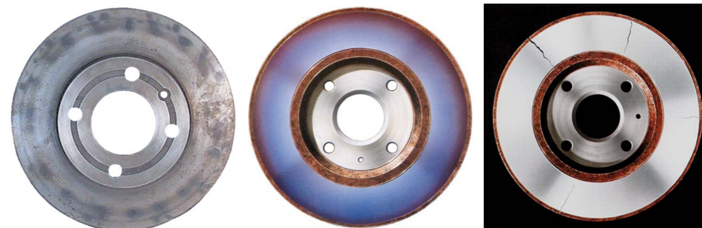
TARCZA BEZWZGLĘDNIE WYMAGA WYMIANY. JEŚLI: USZKODZENIA JEJ POWIERZCHNI NIE ROZKŁADAJĄ SIĘ RÓWNOMIERNIE (Z LEWEJ), MATERIAŁ ULEGŁ PRZEBARWIENIU ŚWIADCZĄCEMU O TERMICZNYCH ZMIANACH JEGO WEWNĘTRZNEJ STRUKTURY (ZDJĘCIE ŚRODKOWE), POJAWIŁY SIĘ JAKIEKOLWIEK PĘKNIĘCIA PŁASZCZYZN CIERNYCH (Z PRAWIEJ)
