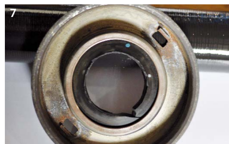
SKUTEK JEDNORAZOWEGO PRZECIĄŻENIA KOŁA
