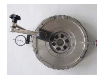
POMIAR LUZU PROMIENIOWEGO WZAJEMNEGO ŁOŻYSKOWANIA MAS
