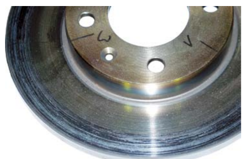
PRZY NIEZNACZNYCH UBYTKACH POWIERZCHNI I ŚLADACH JEJ PRZEGRZANIA MOŻNA TARCZĘ DOPUŚCIĆ DO DALSZEGO UŻYTKU, ALE PRZEWAŻNIE NIE WARTO
