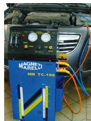
URZĄDZENIE MAGNETI MARELLI PRZEZNACZONE DO DYNAMICZNEJ WYMIANY PŁYNU ATF
