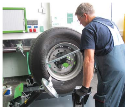
MONTAŻOWNICA TCE 5210 Z POZIOMYM WRZECIONEM I MOBILNYM PULPITEM
