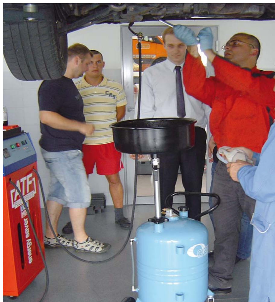
USUWANIE STAREGO PŁYNU ATF NA PODNOŚNIKOWYM STANOWISKU SERWISOWYM Z UŻYCIEM WANNY SPUSTOWEJ I URZĄDZENIA LIQUI MOLY JAKO POMPY NAPEŁNIAJĄCEJ
