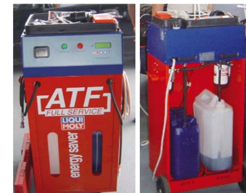
URZĄDZENIE LIQUI MOLY PRZEZNACZONE DO DYNAMICZNEJ WYMIANY PŁYNU ATF ZAWIERA PANEL STERUJĄCY, DRUKARKĘ, ZBIORNIKI NA NOWY I PRZEPRACOWANY PŁYN, WAGI DO AUTOMATYCZNEJ KONTROLI PRZEPŁYWU, ZESTAW FILTRÓW I PRZYŁĄCZA
