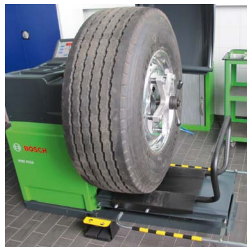
WYWAŻARKA WBE 4430 PRZYSTOSOWANA DO OBSŁUGI WIELKICH ROZMIARÓW KÓŁ
