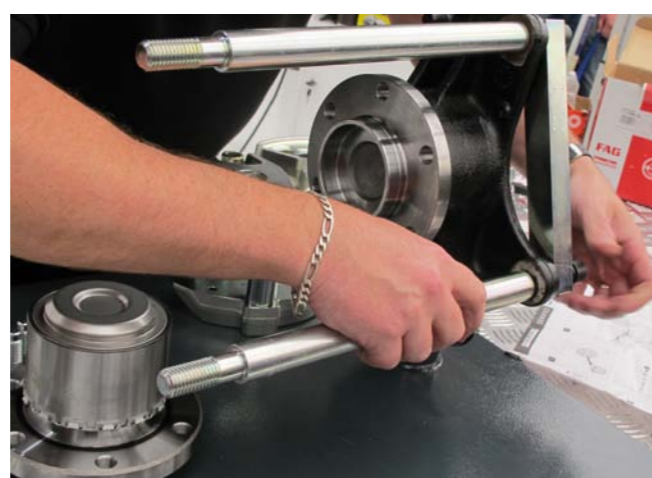
MOCOWANIE NARZĘDZIA MONTAŻOWEGO DO ZWROTNICY (POZOSTAJĄCEJ W ZAWIESZENIU POJAZDU) PRZED DEMONTAŻEM ZUŻYTEGO ŁOŻYSKA WRAZ Z PIASTĄ KOŁA
