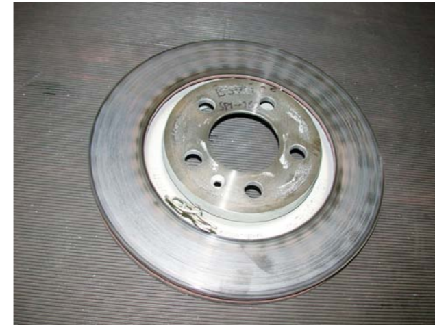
TARCZA ZIMMERMANN PO 200 PRÓBACH PRZECIĄŻENIOWYCH
