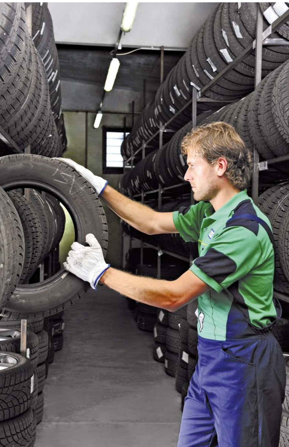
W MAŁYCH, RĘCZNIE OBSŁUGIWANYCH MAGAZYNACH NAJLEPIJ JEST KOMPLETNE KOŁA UKŁADAĆ NA DOLE POZIOMYMI WARSTWAMI, A OPONY – PIONOWO NA REGAŁACH
