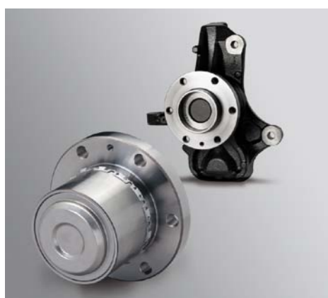
MODUŁ ŁOŻYSKA FAG. NA ŁOŻYSKU WIDĄC PIERŚCIEŃ OSADCZY ZE SPRĘŻYSTYMI ZACZEPAMI BLOKUJĄCYMI SIĘ W OBWODOWYM RÓWKU GNIAZDA ZWROTNICY
