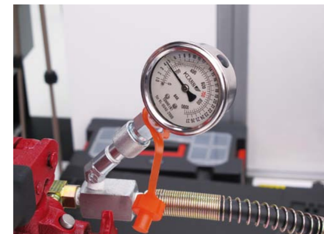
NA POCZĄTKU CIĄGNIĘCIA CIŚNIENIE W POMPIE I ŚCIĄGACZU SZYBKO ROŚNIE, A JEGO NAGŁY SPADEK SYGNALIZUJE ZERWANIE ZACZEPÓW PIERŚCIEŃ OSADCZEGO
